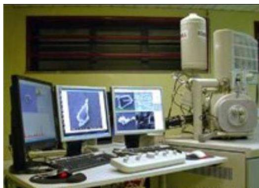
**Fig. 3.45** – Microscópio eletrónico de varrimento SEM JSM 35C/Noran Voyager de CEMUP [88].
