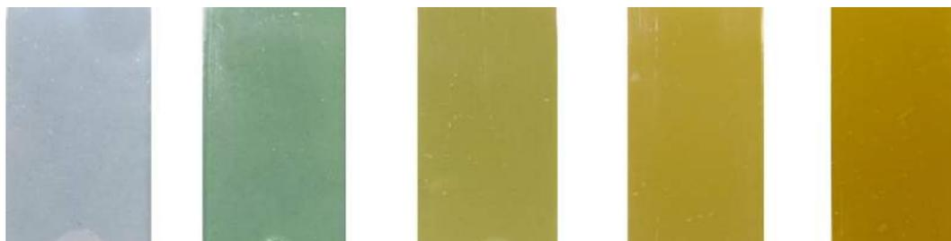
**Fig. 2.11** – Filmes finos de ouro depositado sobre uma lâmina de vidro de sílica com ordem crescente de espessuras, em escala nanométrica.
