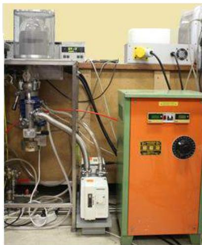
**Fig. 3.44** – Evaporador térmico resistivo.
