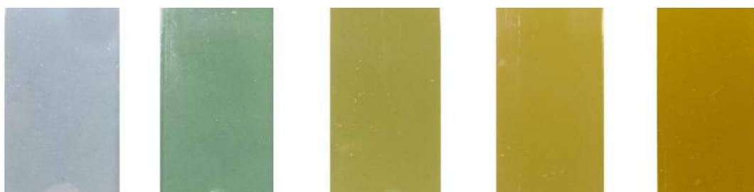
**Fig. 3.32** – Filmes finos das amostras de Au de 1,051 mg; 4,683 mg; 14,180 mg; 18,976 mg e 111,617 mg, respetivamente.
