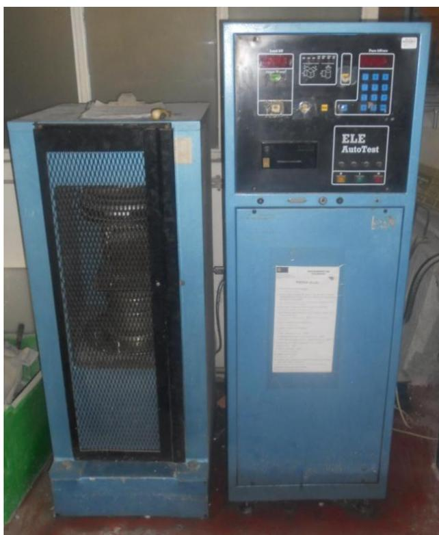
Figura 14 - Prensa hidráulica existente no laboratório de materiais de construção (UM)
