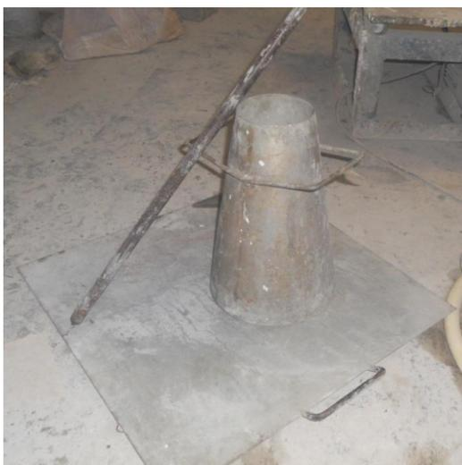
**Figura 11 - Cone de Abrams utilizado para o ensaio de abaixamento**
