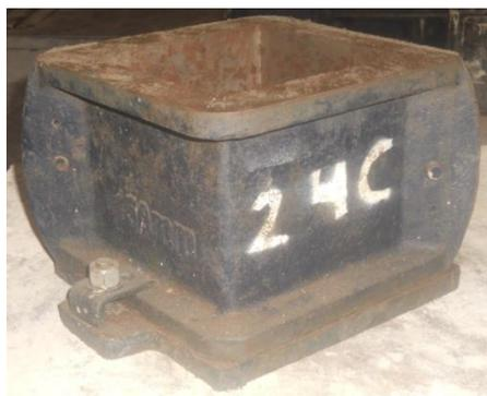
**Figura 12 - Exemplo de molde utilizado nas amassaduras**
