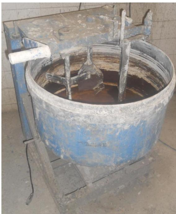
Figura 10 - Betoneira utilizada nas amassaduras
