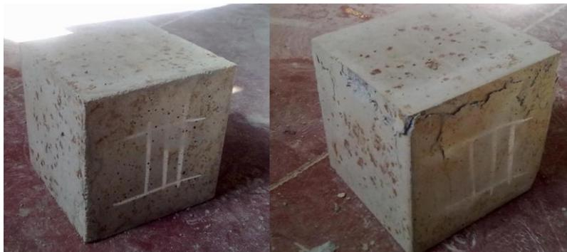
Figura 15 - Provete antes e depois do ensaio para determinação da classe de resistência à compressão
