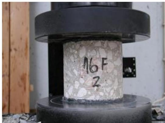
**Figura 6 - Carote que demonstra a pasta de cimento envolvendo os agregados**
