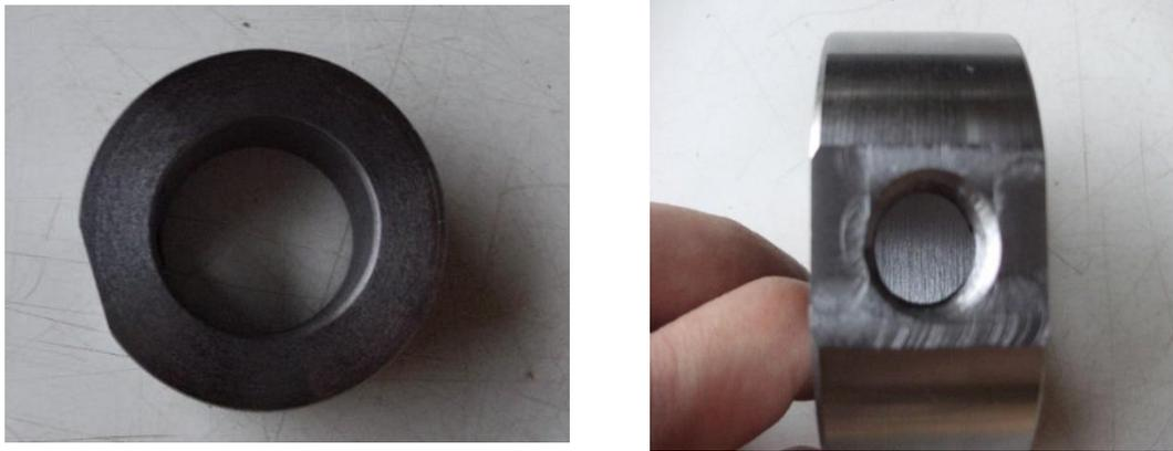
**Figura 4.14 Suporte superior fabricado**
