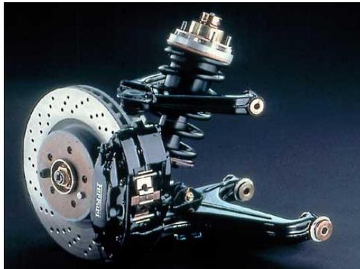
Figura 2.1 Suspensão passiva [2]
