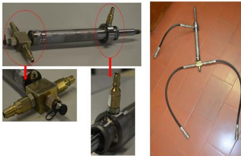
Figura 4.19 Amortecedor finalizado com o pormenor dos racores e manguerias
