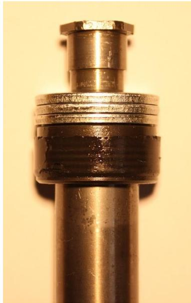
**Figura 4.16** Constituição do pistão do amortecedor regenerativo
