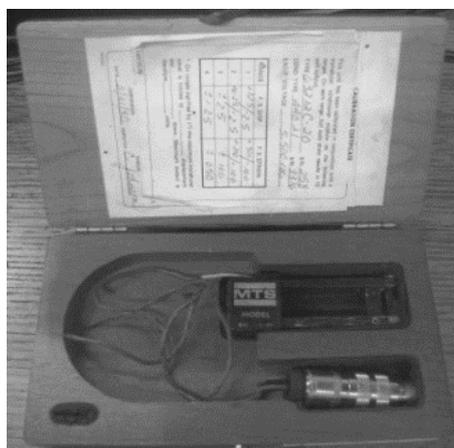
Figura 4. 6 Extensómetro mecânico MTS modelo 632 12C-20.
