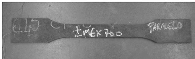
Figura 4. 1 Provete para ensaio de tração.
