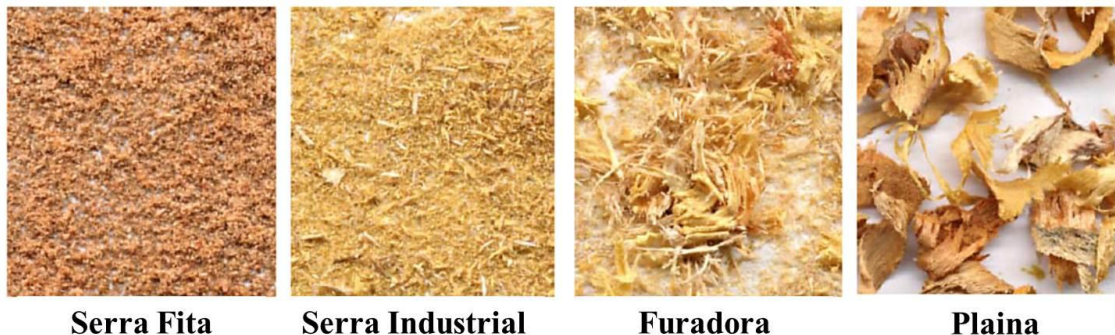
Figura 2.4 - Resíduos provenientes de operações mecânicas
