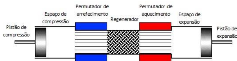
Figura 3.3 – Configuração Alfa do motor Stirling (adaptado de: (Urieli, 2010))
