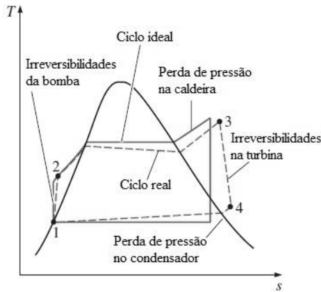
Figura 2.3 – Diagrama T-s do ciclo Rankine ideal e real (adaptado de: (Çengel & Boles, 2006))
