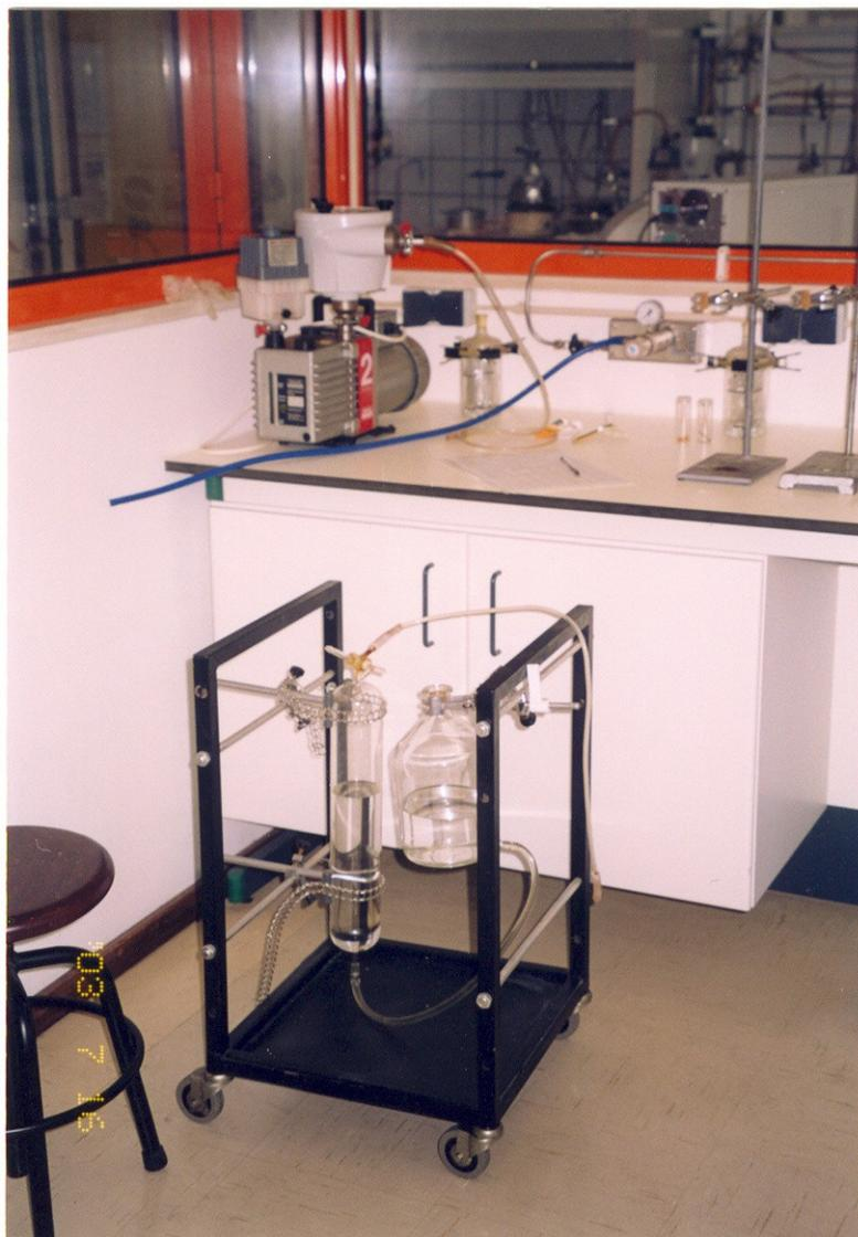
Figura 2.4 - Bureta de gases para medição do volume de oxigénio.
