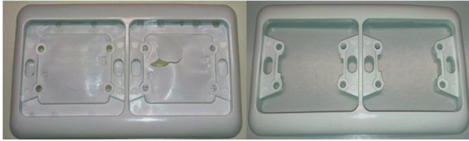
Figura 31 - Peça por rebarbar (lado esquerdo); peça rebarbada (lado direito)
