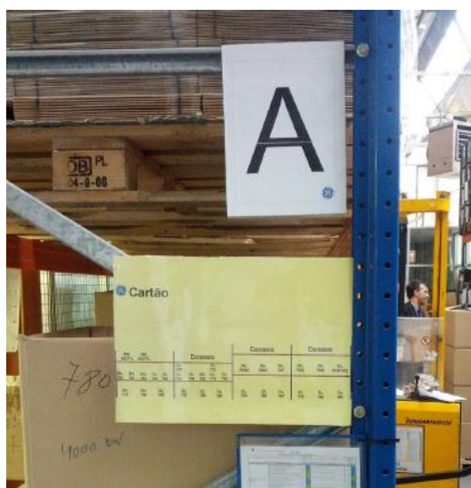
Figura 69 - Exemplo de identificação de um corredor no armazém
