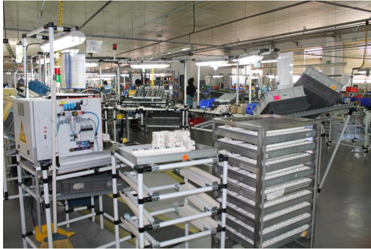
Figura 21 - Parte da Secção de Montagem do ELCB
