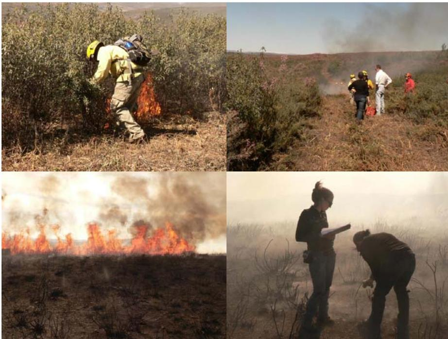
**Figura 2.** Realização da queima dos matos por fogo controlado na área de estudo e medição da temperatura do solo após a passagem da frente de fogo (Março de 2011)
