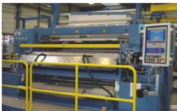
Figura 28: Máquina de laminar Cavitec da Santex, da linha Caviflex Fonte: http://www.cavitec.ch/en/?menu=produkteprogramm
