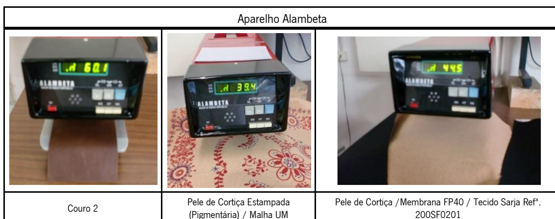
Figura 22: Algumas imagens de ensaios realizados no aparelho Alambeta Fonte: Autora
