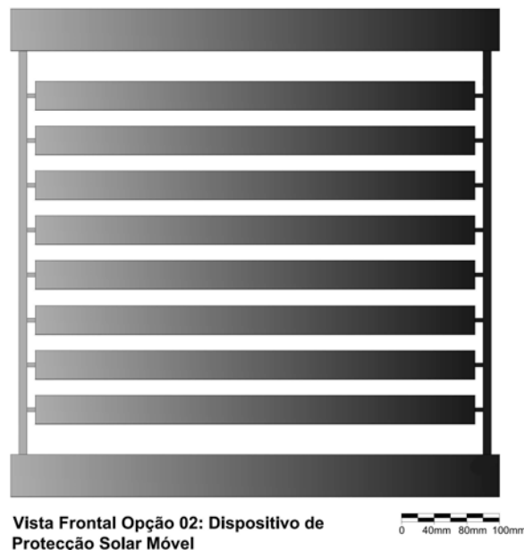
Figura 6.63 Vista de uma segunda opção considerando pequenas palas móveis.
