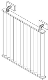
Figura 6.7 Dispositivo de proteção solar vertical e sua instalação no módulo padrão.
