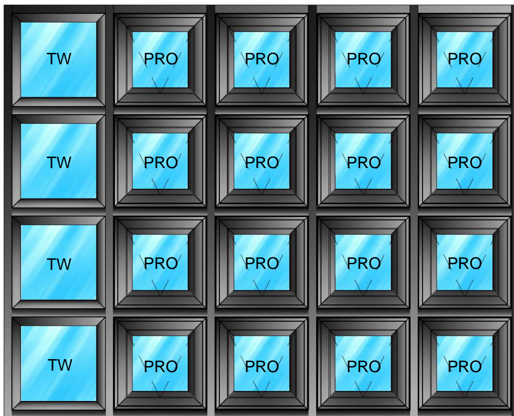
Figura 6.72 Módulo padrão projetante (PRO) e módulos parede de Trombe (TW).
