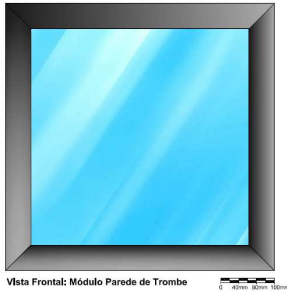
Figura 6.23 Módulo Parede de Trombe.
