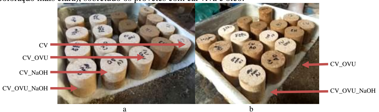
Figura 3: provetes durante o ensaio de absorção de água por capilaridade: a – 1h e b – 24h
