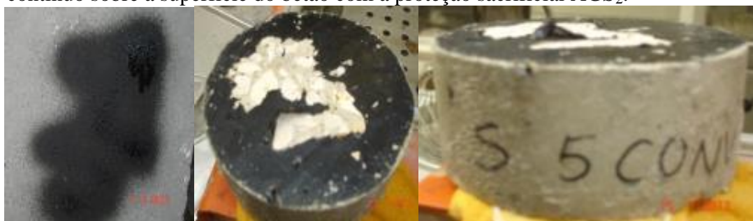
Figura 5. Processo de remoção da tinta em spray da superfície do betão com proteção sacrificial AGS 2
