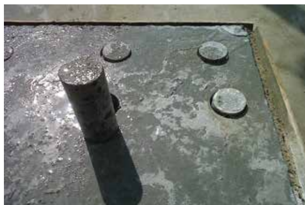
Figura 10 – Cura das carotes em condições atmosféricas do local
