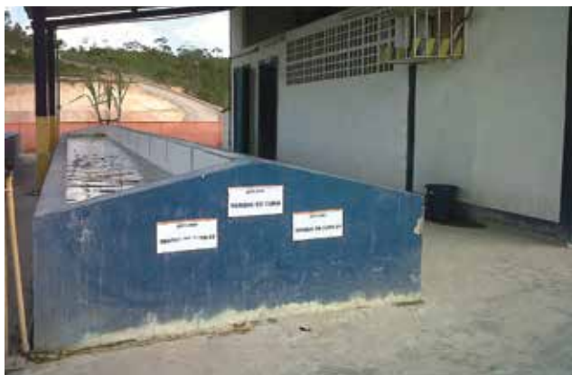
Figura 7 – Cura dos provetes – PR – em condições de laboratório
