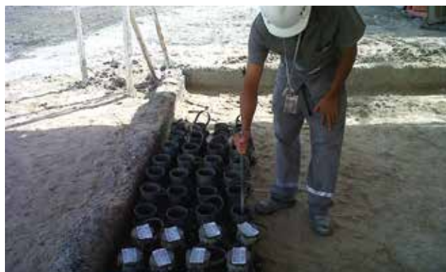
Figura 6 – Moldagem dos provetes
