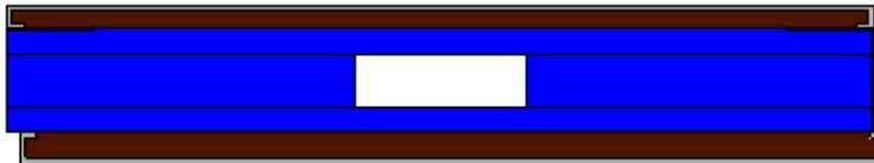
Figura 7 – Vista de topo do módulo com orifício para passagem de tubagens
