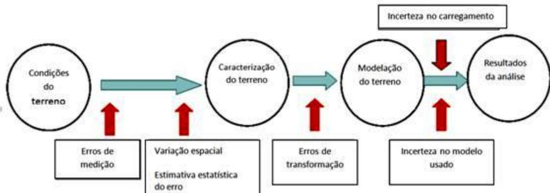
Figura 1.3: Incerteza nas várias etapas de modelação de uma obra geotécnica, (adaptado de Honjo, 2011).
