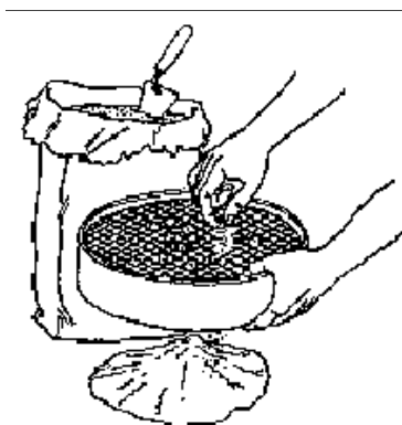
Figura 2.12: Exemplo de teste ao cimento (RIGASSI, 1985).
