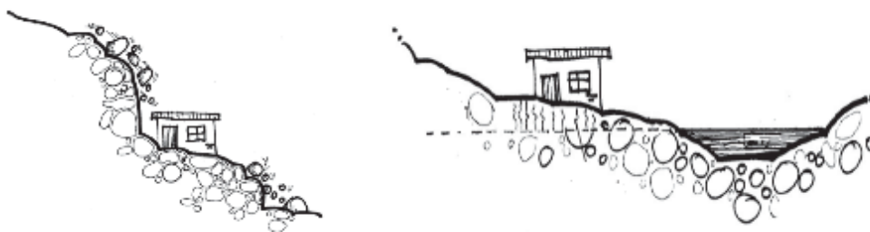
Figura 5.1: Imagem exemplo com os locais de implantação a evitar (BLONDET et al., 2005).
