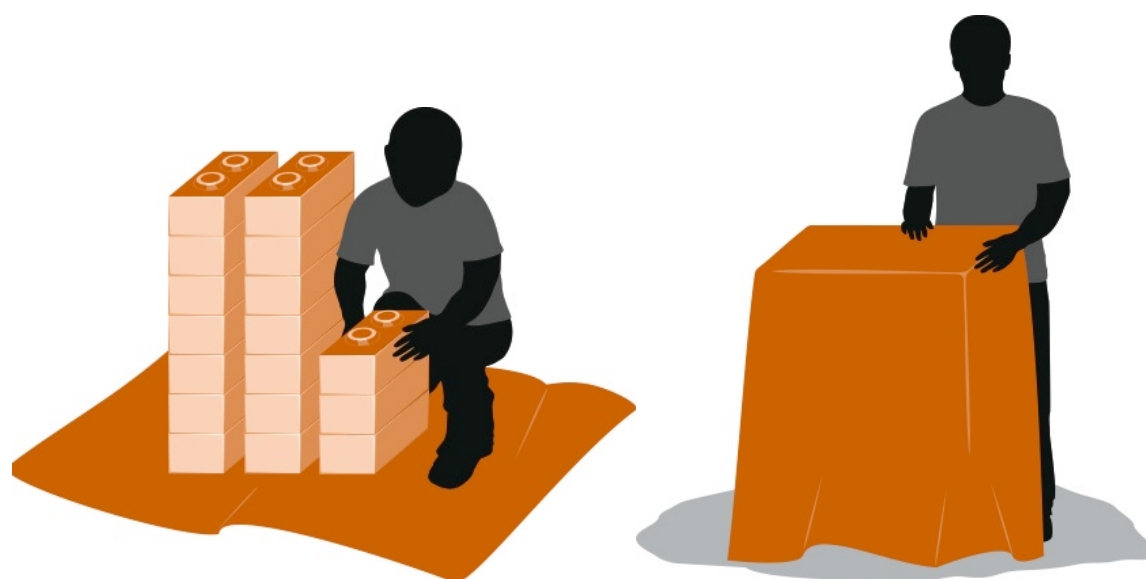
Figura 6.5: Imagem a utilizar no manual para demonstrar o processo de condicionamento e proteção dos blocos (HiLoTec, 2012).
