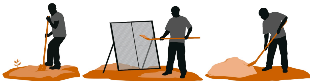
Figura 6.4: Imagem a utilizar no manual para realizar a peneiração do solo recolhido (HiLoTec, 2012).
