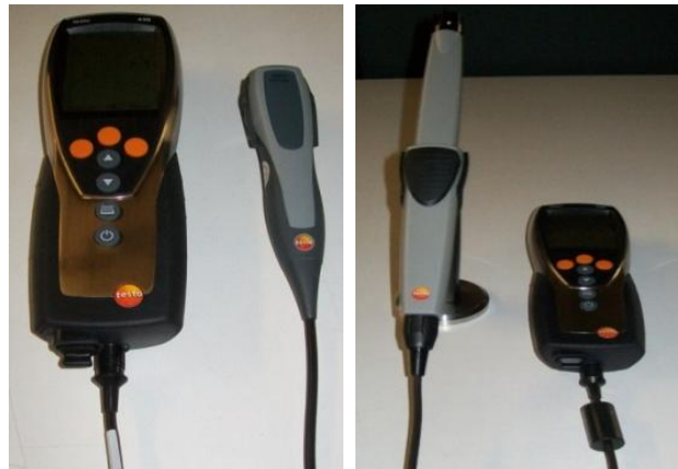
Figura II.5 – Mostrador do sensor de CO e de CO 2 da Testo modelo 435
