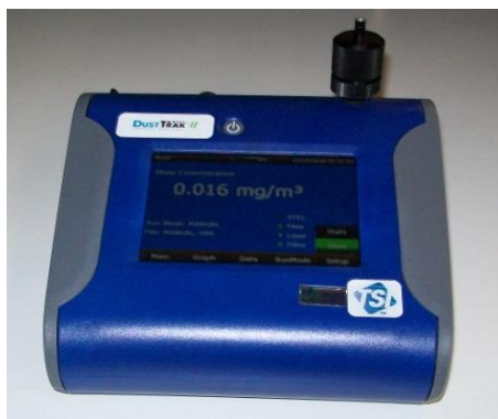
Figura II.4 – Mostrador do sensor de partículas DUSTTRAK™ II Desktop Aerosol Monitor Models 8530/8531
