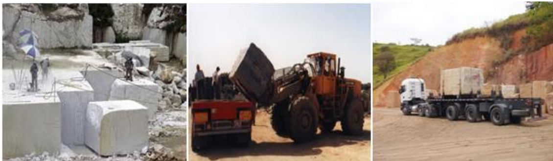
Figura 7 - Desmorte, carga e transporte da rocha extraída
