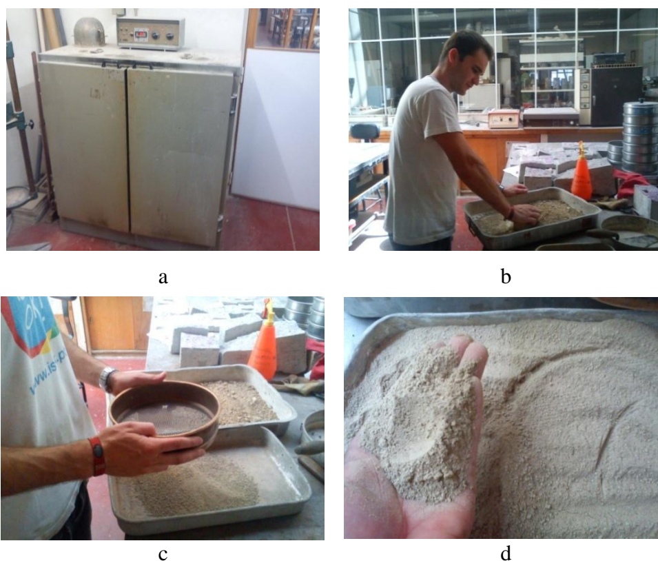
Figura 25 - a) Estufa b) Trituração e esmagamento da Lama c) Peneiração d) Lama após passar no peneiro
