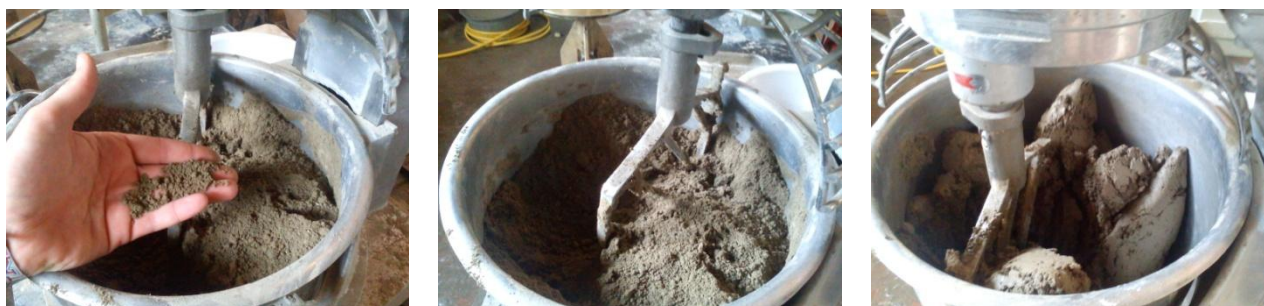
Figura 31 - Amassaduras da argamassa com Lama Cozida
