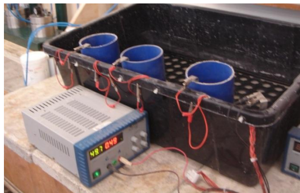
Figura 20 - Ensaio de difusão dos cloretos por migração
