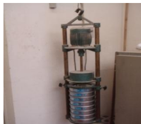
Figura 8 - Série de peneiros e máquina de agitação para análise granulométrica
