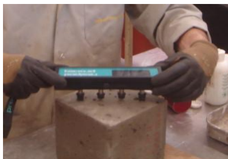
Figura 23 - Medição da resistividade com o RESIPOD
