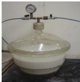
Figura 19 - Exsicador com provetes imersos na solução de \text{Ca(OH)}_2
