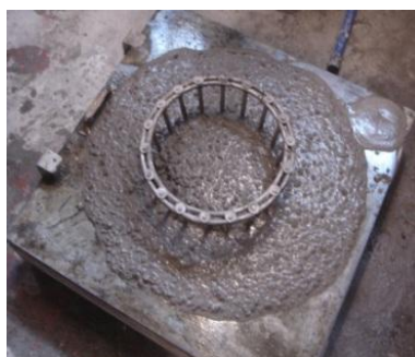
Figura 25 - Ensaio de espalhamento no interior do anel J
