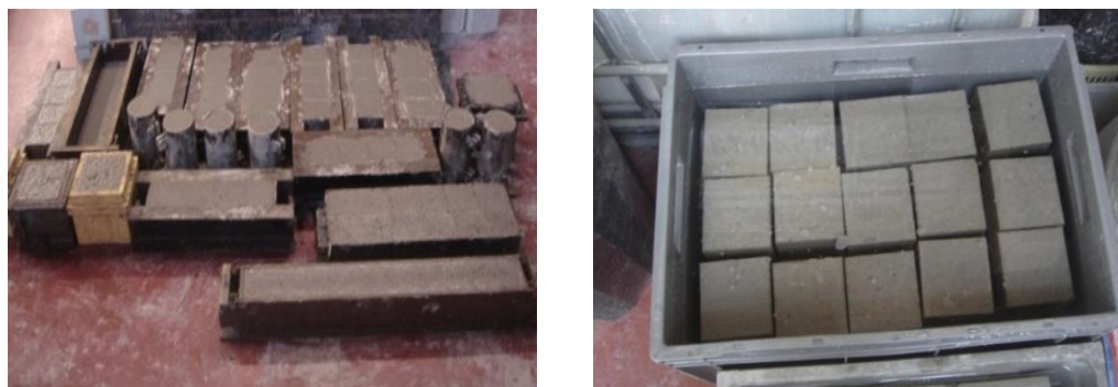
Figura 15 - Moldes e cura dos diversos provetes
