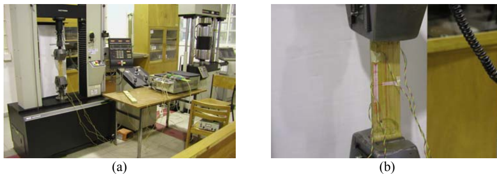
Figura 2 – Ensaio destrutivo: (a) vista geral e (b) pormenor de uma das faces.
