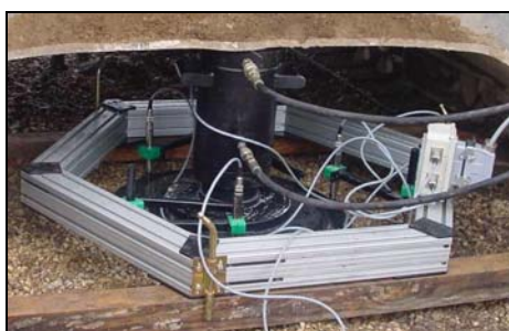
Figura 6 – Equipamento de ensaio automático de placa em solo.
