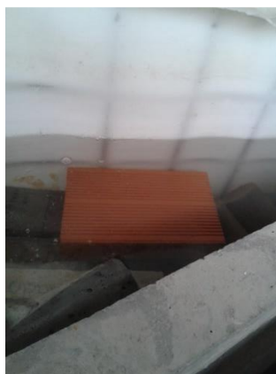
Figura 4.4 – Tanque com tijolo totalmente submerso
