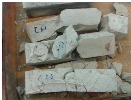
Figura 5.6 – Provetes de Cal hidráulica + PCM + Fibras submetidos a 600 °C
