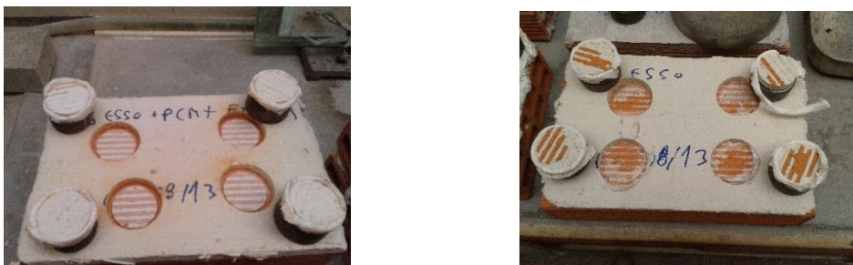
Figura 5.25 – Rompimento da argamassa Gesso + PCM + fibras e Gesso
