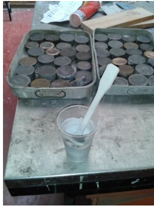
Figura 4.11 – Peças metálicas com 50mm diâmetro e cola de alta resistência
