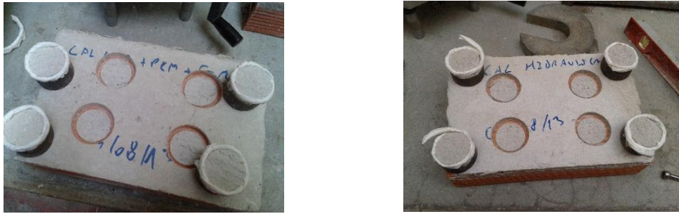
Figura 5.23 – Rompimento da argamassa Cal hidráulica + PCM + fibras e Cal hidráulica
