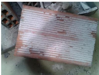
e) Argamassa de cal aérea + PCM + fibras
