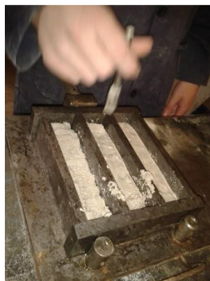
Figura 4.3 – Provetes 4*4*16 \text{ cm}^3 e processo compactação
