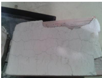
c) Argamassa de gesso + PCM + fibras
