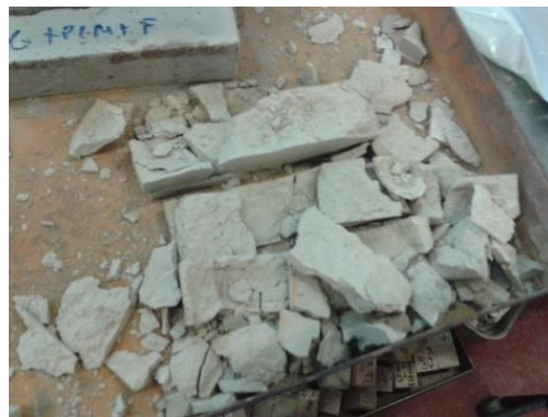
Figura 5.2 – Provetes de Cal aérea + PCM + Fibras submetidos a 600 °C
