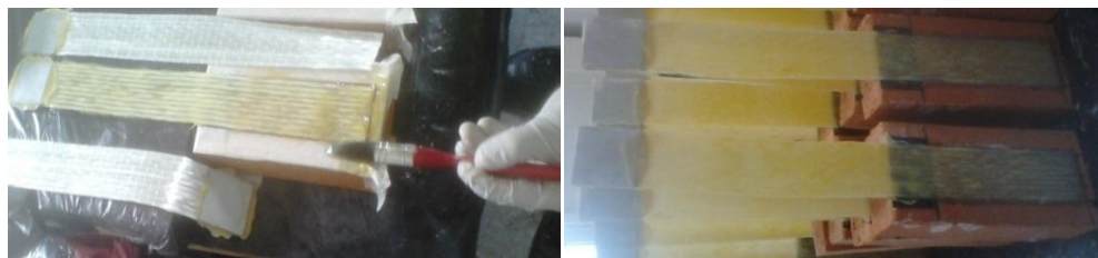
e) Aplicação da resina epóxi.
