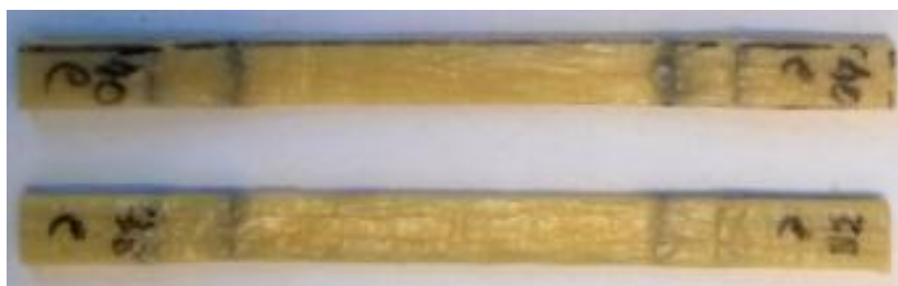
Figura 8 – Esquema ilustrativo da forma dos provetes de GFRP.
