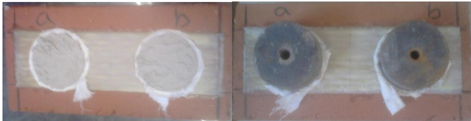
e) Colocação de panos e cola adesiva. f) Colocação do pull-head.
