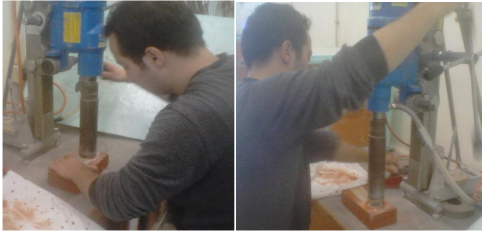
c) Realização dos cortes circulares. d) Área de ligação a ser testada.
