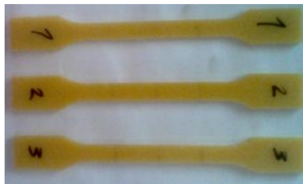
Figura 7 – Esquema ilustrativo da forma dos provetes de resina.
