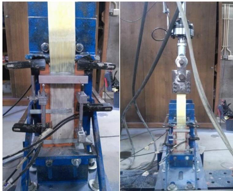
c) Colocação dos LVDT's. d) Realização do ensaio.
