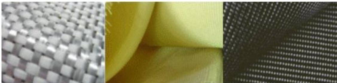
Figura 3 – Fibra de vidro (à esquerda), de aramida (ao centro) e de carbono (à direita) (PUC, s.d).
