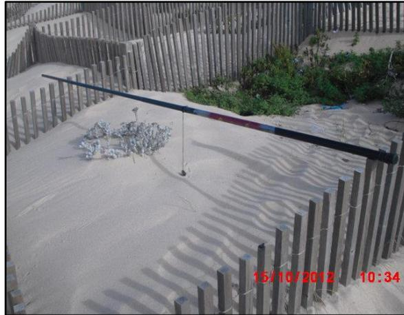
Figura 14: Uso da cana extensível para medição de alturas no interior das paliçadas.
