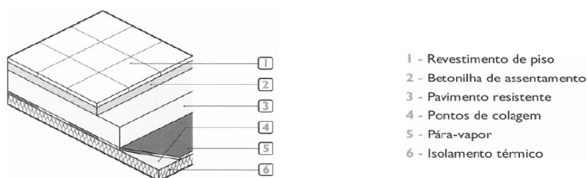
Figura 12 - Pavimento sobre espaço não-aquecido - isolamento térmico inferior [4]
