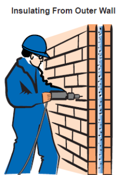
Figura 9 – Injeção de material isolante na caixa-de-ar [7]
