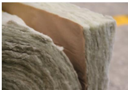
Figura 23 – Manta de lã de rocha [13]
