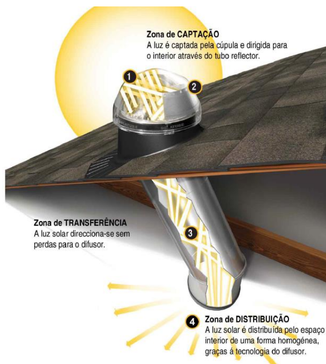
Figura 35 - Tubo solar - Solatube [29]
