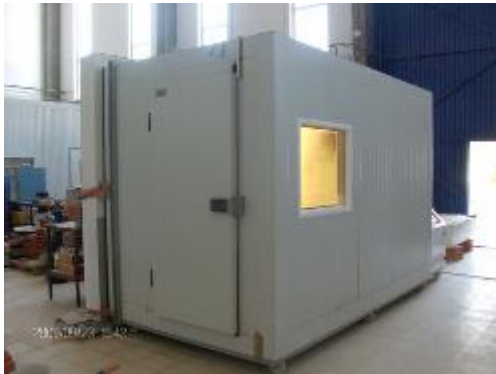
Figura 34: Ensaio em curso com câmara higrotérmica aplicada sobre sistema ETICS com ICB
