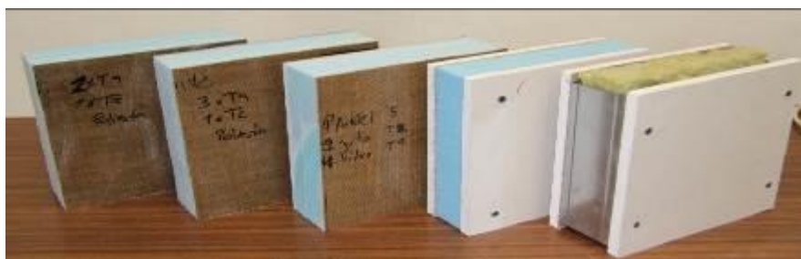
Fig. 4:Provetes desenvolvidos (da esquerda para a direita): 2T9+T2, 3T9+T2, 4T9+T2, Painel Gesso + XPS e Parede Gesso + Isolamento (o mesmo provete foi utilizado para a “Parede Gesso” contudo sem a manta de lã de rocha)
