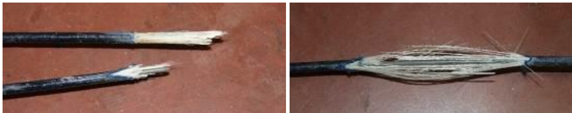
Fig.10 Aspecto pós-rotura dos varões do Tipo 2: Amostra 1 (à esq.) e Amostra 4 (à dir.)
