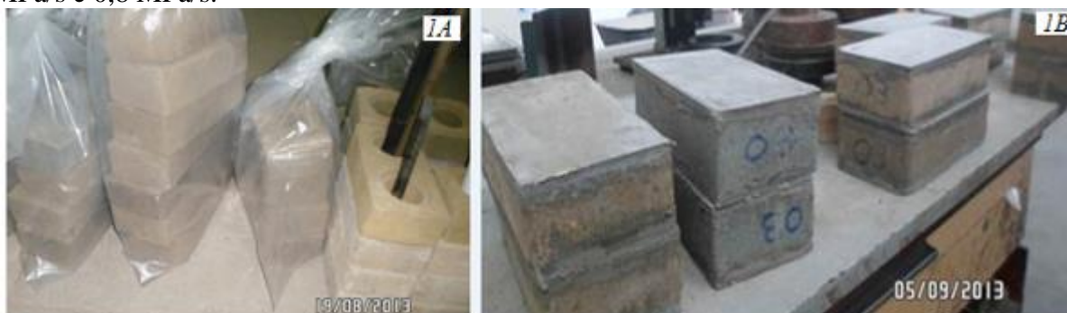
Figura 1. Blocos em processo de cura (1A) e blocos capeados com cimento (1B) para os ensaios de resistência à compressão simples.
