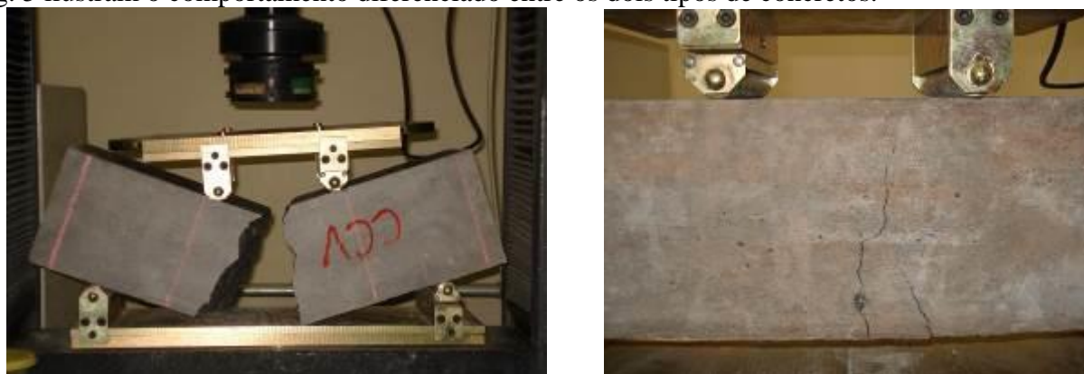
Figura 5: Ensaio de resistências à tração na flexão
