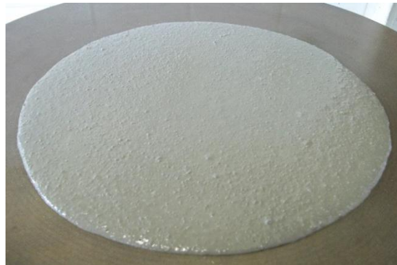
Figura 7 - Mistura com grãos médios de EVA (16 Mesh) e proporção de incorporação de 4% após o espalhamento.
