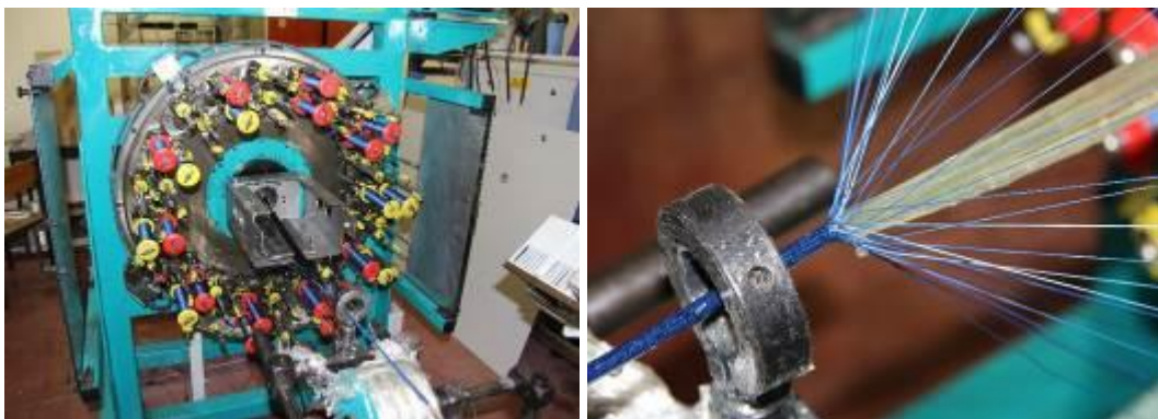
Fig.3 Fotografia do equipamento de entraçamento (à esquerda) e do varão na etapa de entraçamento (à direita).
