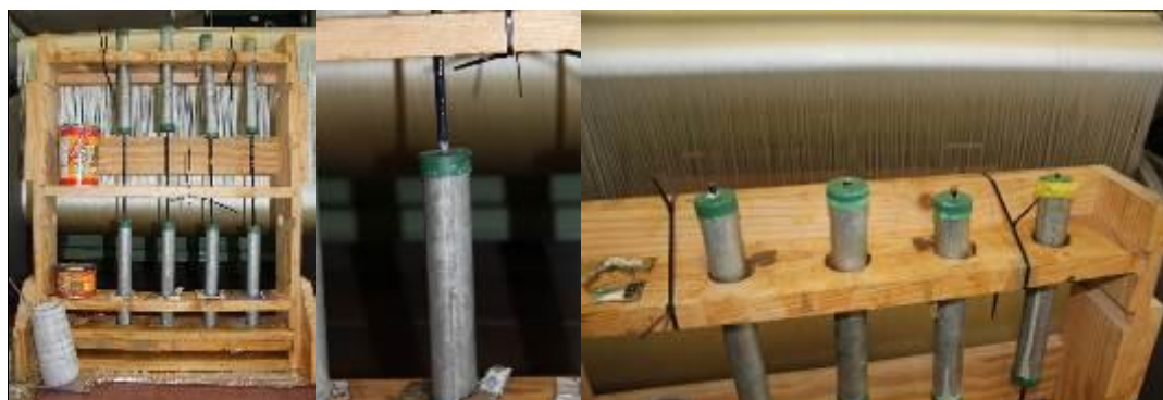
Fig.6 Metodologia de preparação dos provetes para ensaio através da utilização de ancoragens metálicas
