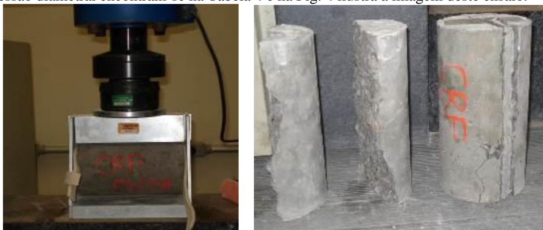
Figura 4: Ensaio de resistências à tração por compressão diametral
