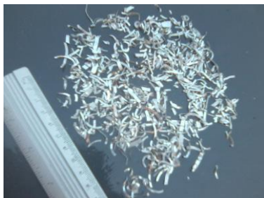
(Fig 01) - Fibras de alumínio adicionadas à argamassa ( \varnothing = 0,2 e L = 20,0 [mm]) Razão de aspecto – 60.
