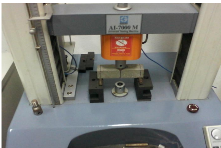
Figura 4 – Arranjo de ensaio de flexão em três pontos para uma amostra prismática.
