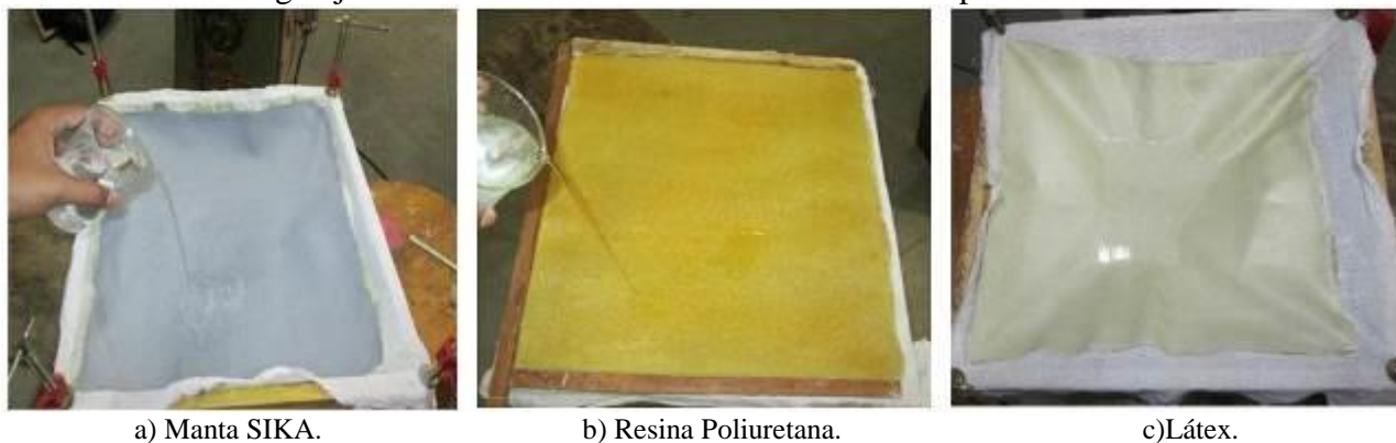
Figura 5: Testes de estanqueidade.
