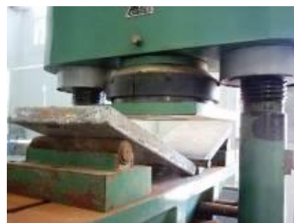
Figura 12: Ruptura da placa branca
