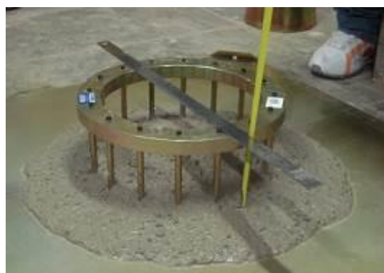
Figura 6 - Variação de segregação dos diferentes traços de CAA e a execução do ensaio Anel J no traço com 20% de metacaulim.
