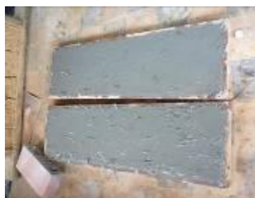
Figura 9: Placas de concreto armado com fibras de PET
