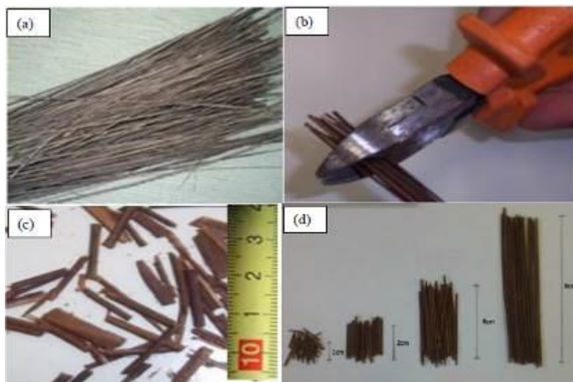
Figura 2 - Processo de corte e seleção das fibras: (a) fibras in natura, (b) corte, (c) medição e (d) separação dos comprimentos.
