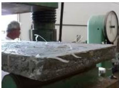
Figura 15: Placa com adição de fibra de PET
