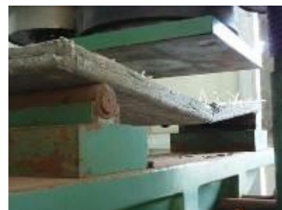
Figura 17: Ruptura da placa com adição de fibra de PET
