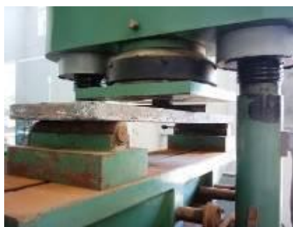
Figura 11: Placa branca submetida à carga pontual no meio do vão
