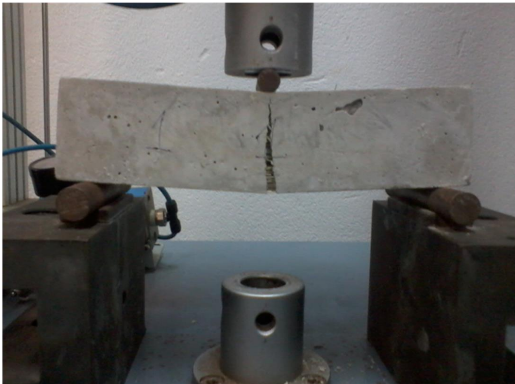
Figura 2 - Corpo-de-prova CP1 reforçado com fibra de sisal no ensaio de tração na flexão.
