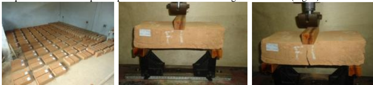
Figura 2. Secagem dos adobes, início e finalização do ensaio de flexão.
