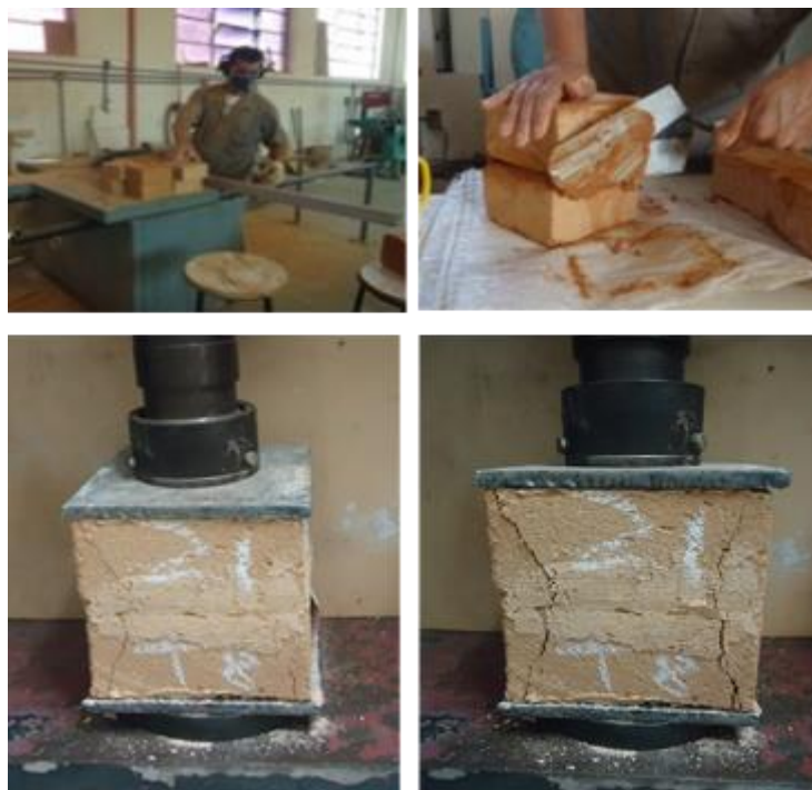
Figura 1. Preparo dos corpos de prova e ensaio de compressão
