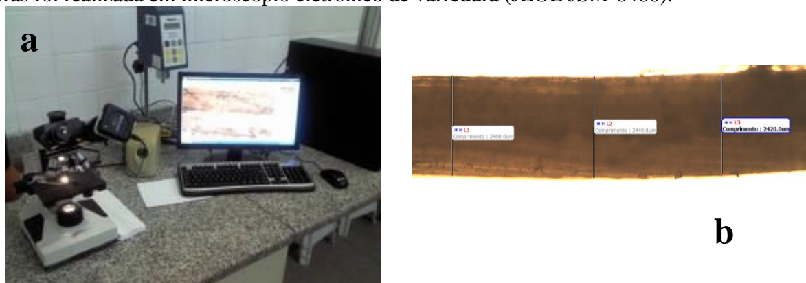
Figura 1. Determinação do diâmetro da fibra: a) microscópio óptico; b) aferição da fibra
