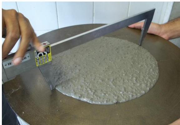
Figura 8 - Medição do espalhamento de uma mistura com grãos grandes de EVA (8 Mesh) e proporção de incorporação de 2%
