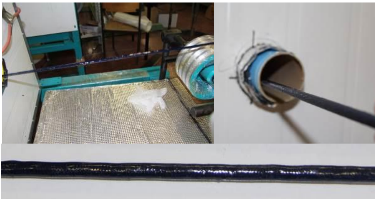
Fig.4 Fotografia de um varão composto entrançado durante o processo produtivo: após o entrançamento e antes da estufa de cura (em cima à esquerda), após a estufa de cura (em cima à direita.) e após a cura completa (em baixo).
