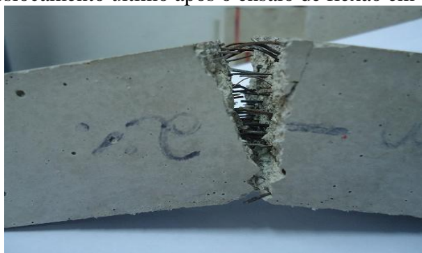
Figura 18 - Corpo-de-prova (com fibras 4 cm e teor de incorporação 2%) que apresentou o maior deslocamento após o ensaio de flexão.
