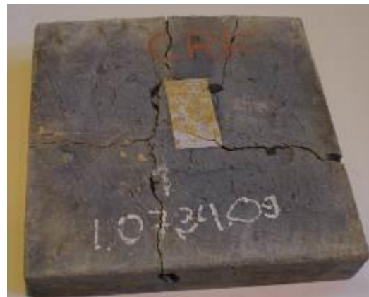
(b) concreto reforçado com fibra de aço (CRFA)
