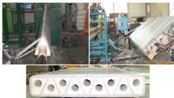
Figura 5- Processo de Filament Winding na fabricação de painéis compósitos.
