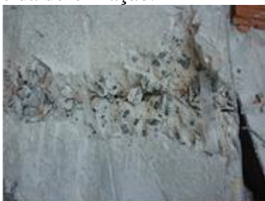
Figura 18: Fibras de PET sem avarias após o rompimento das placas (vista superior)
