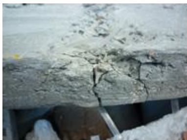
Figura 19: Fibras de PET sem avarias após o rompimento das placas (vista lateral)
