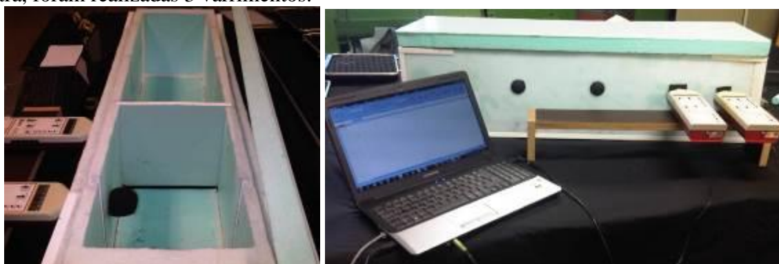
Fig. 6: Interior da caixa de ensaios acústicos (à esquerda) e montagem utilizada (à direita).
