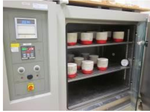
Figura 33: Ensaio de permeabilidade ao vapor de água
