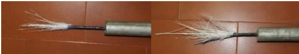
Fig.9 Aspecto pós-rotura da Amostra 5 do Varão de Tipo 1
