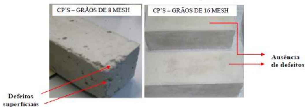
Figura 6 - Comparação da qualidade das superfícies dos corpos-de-prova com grãos de EVA de 8 Mesh e 16 Mesh.
