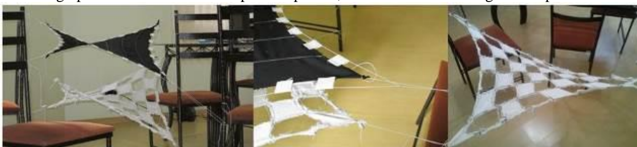
a) Configurações geométricas. b) Condições de contorno. c) Distorção dos vazios.
