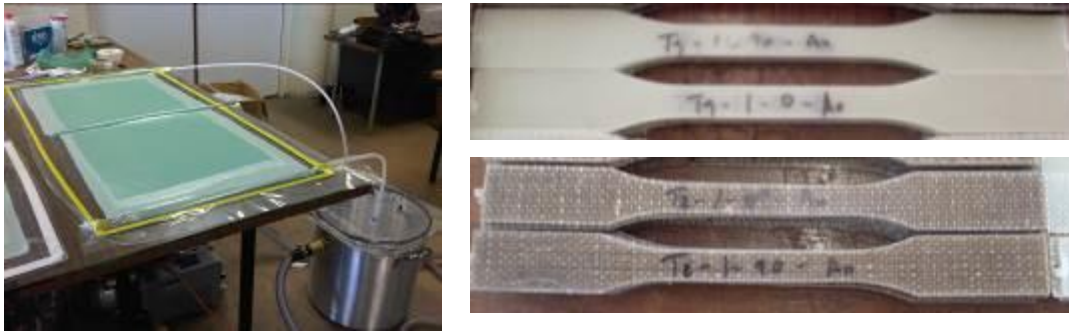
Fig. 2: Impregnação por infusão por vácuo (à esquerda), provete de compósito com resina de poliéster/fibra de juta (em cima à direita) e de um compósito resina de poliéster/fibra de vidro (em baixo à direita)
