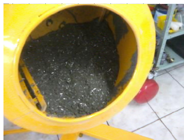
(Fig 02) – Aspecto da argamassa com as fibras de alumínio.
