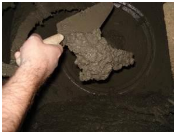
(b) Aspecto do concreto com 51% de teor de argamassa
