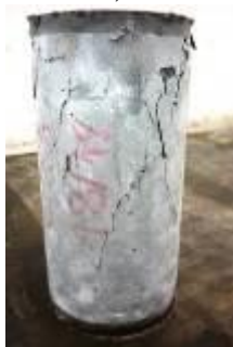
Figura 10: Corpo de prova branco submetido à compressão axial
