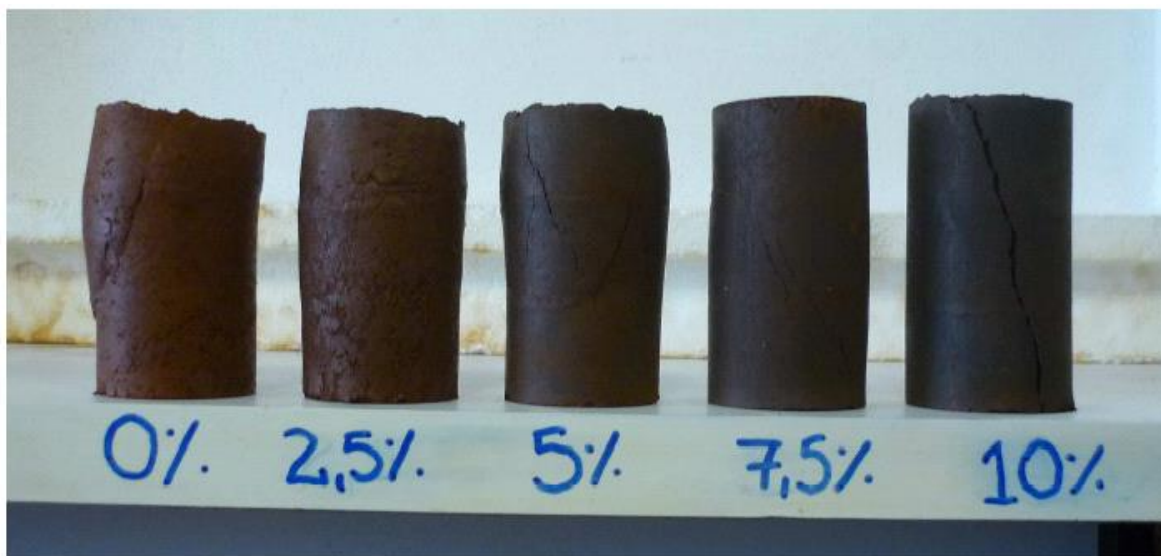
Figura 10. Fotografia dos corpos de prova rompidos para crescentes teores de CCA.
