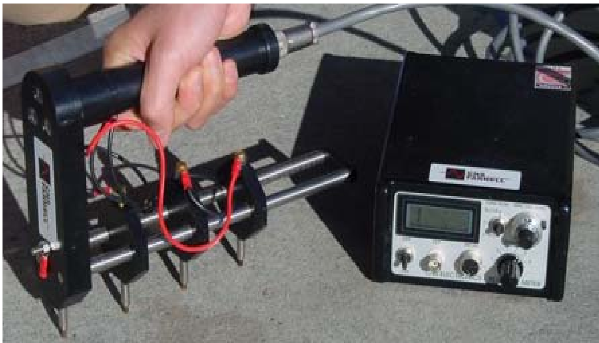
Fig. B1. Måling av betongens elektrisk motstandsevne ved bruk av en Wenner-elektrode [57].
