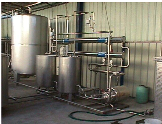
Figura 1.16 Unidade de ultrafiltração da instalação piloto para valorização integral de soro de queijo da Quinta dos Ingleses.
