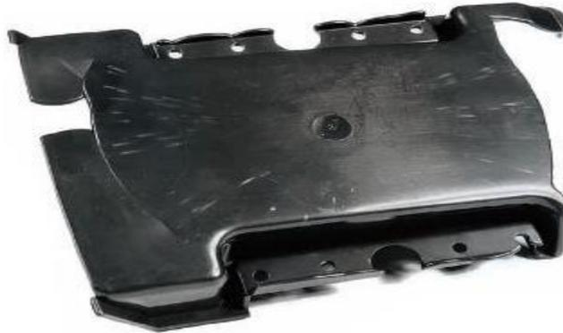
Figura 26 - Raiados (Fonte: ([http://www.tudosobreplasticos.com/processo/solucoes\\_injecao.asp](http://www.tudosobreplasticos.com/processo/solucoes_injecao.asp)))
