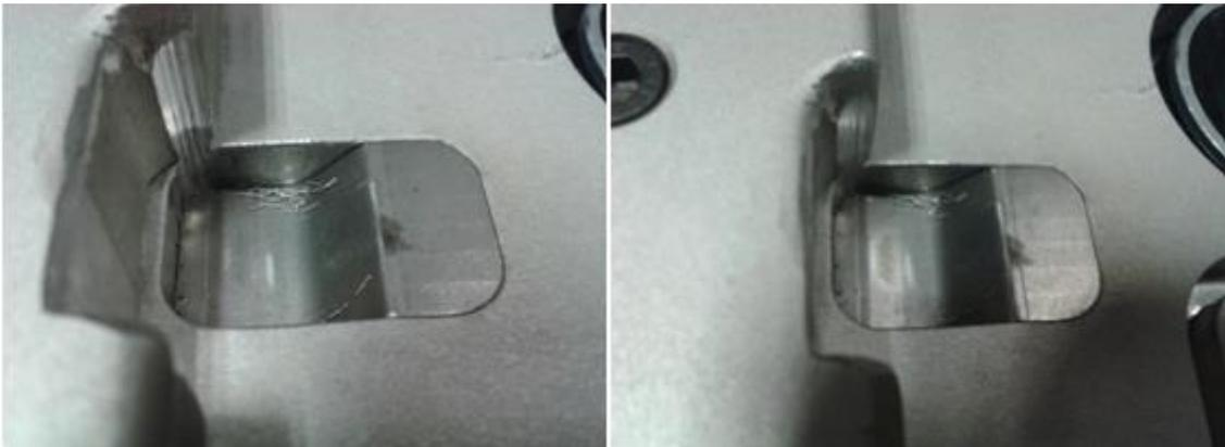
Figura 49- Limalhas na mesa de pré-formação
