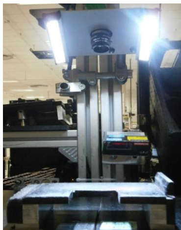
Figura 43 - Camara instalada numa linha de montagem final de auto-rádios
