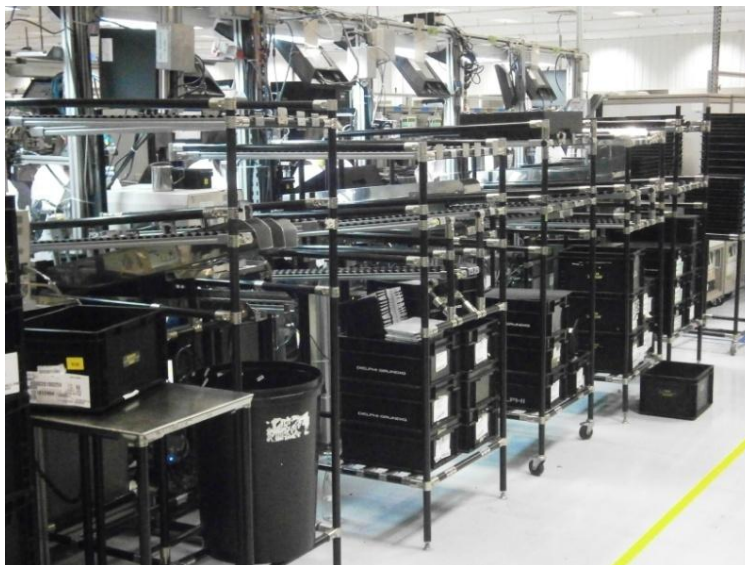
Figura 45 - Rampa de Abastecimento da Linha de Montagem Final 2
