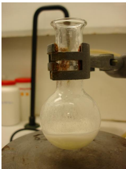
Figura 2.1: Formação do sol precursor de dióxido de titânio por adição do alcóxido TBOT a uma mistura de água e álcool.
