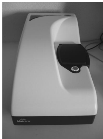
Figura 1.16: Fotografia do aparelho utilizado para a execução da DLD.
