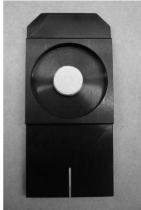
Figura 2.12: Pastilha de dióxido de titânio fixada no transportador de amostra da esfera de integração.
