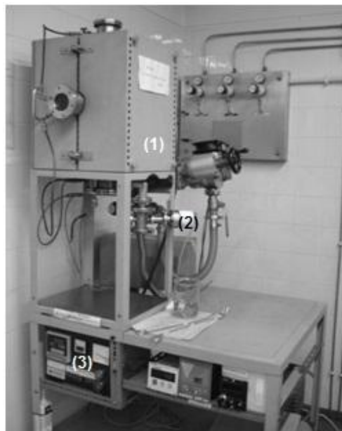
Figura 2.4: (1)Forno de alto vácuo, (2)medidores de pressão e (3)programador de ciclo térmico utilizados para o tratamento térmico das amostras.
