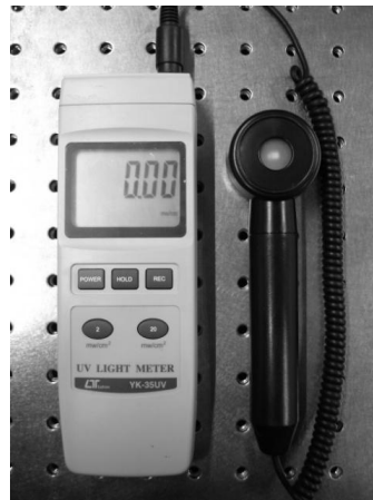
Figura 2.11: Medidor de radiação UV utilizado na monitorização da irradiância incidente nas amostras testadas.
