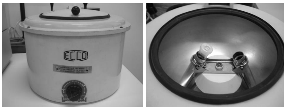
Figura 2.2: Centrifugadora ECCO-PRAXA utilizada para a separação e lavagem das partículas.
