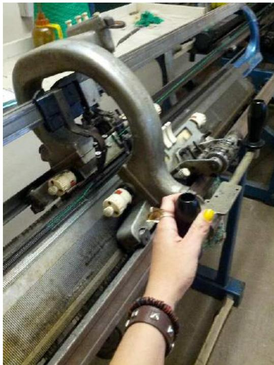
Figura 33 - Familiarização com o tear retilíneo manual.
