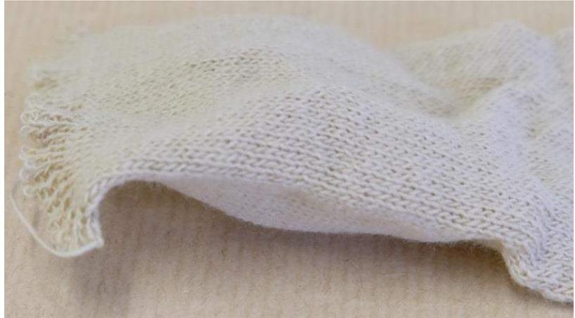
Figura 40 - Afinação das cames para *jersey* tubular e amostra produzida.
