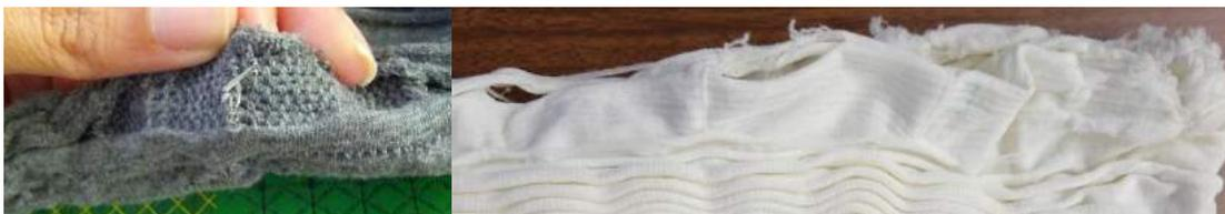
Figura 51 - Agulha quebrada e defeito na malha.
