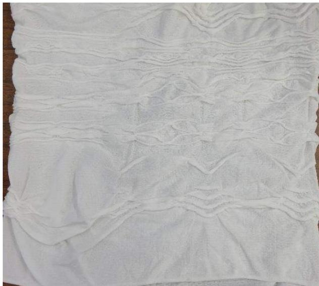
Figura 54 - Amostra de malha com efeito 3D produzida com fio 100% Poliamida, 78 dtex.
