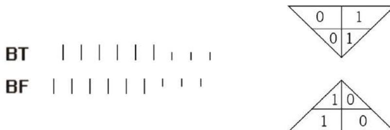
Figura 42 - Agulhamento e afinação das cames para produção de efeitos canelados tubulares.
