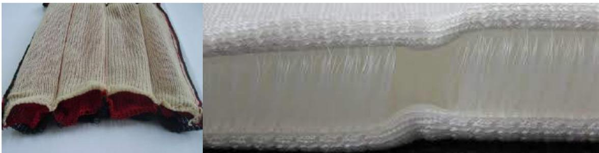
Figura 19 – Malha 3D sanduíche ligada por estrutura (a) e ligada por fios (b). Fonte: (Penciuc et al., 2010)
