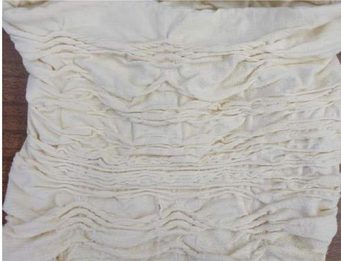
Figura 52 - Amostra de malha com efeito 3D com fio cru 100% algodão e elastômero.
