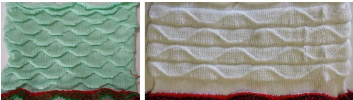
Figura 49 - Amostras de malha com efeito 3D produzidas em tear retilíneo eletrônico.
