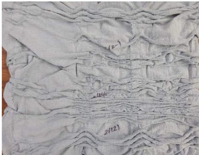
Figura 53 - Amostra de malha com efeito 3D produzida com fio 100% poliamida e elastômero.
