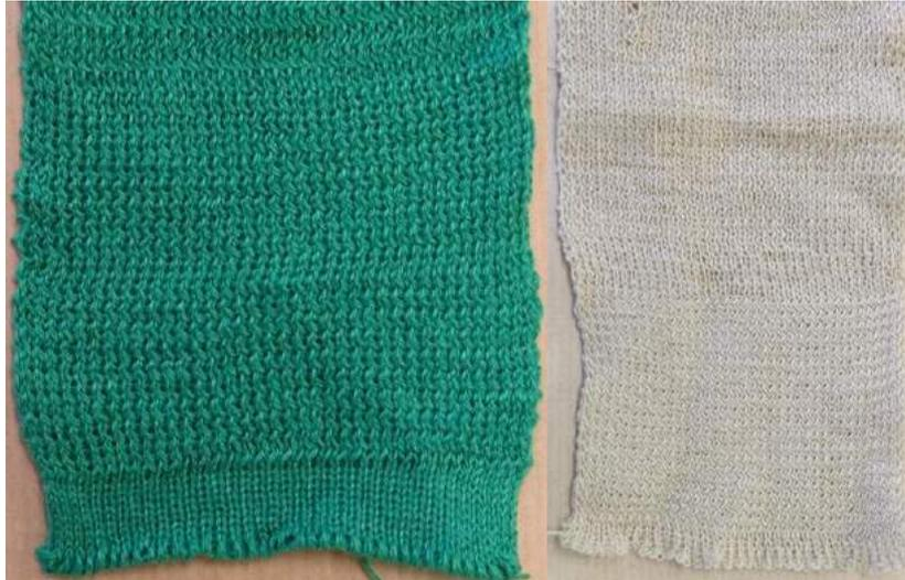
Figura 35 - Amostras com torcimento de bancada: verde - 1 agulha; areia - 2 agulhas.
