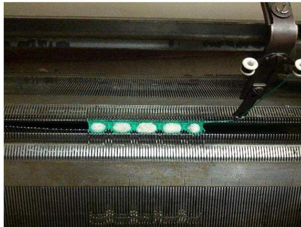
Figura 44 - Inserção de manta acrílica nos tubos antes de fecha-los.
