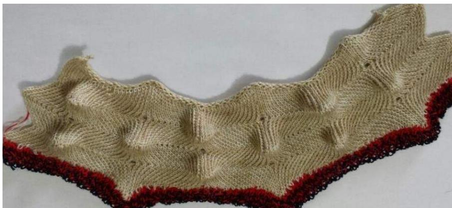
Figura 50 - Amostra de malha com efeito 3D produzida em tear retilíneo eletrônico.
