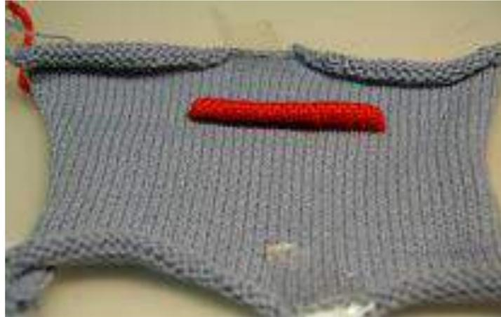
Figura 21 - Efeito 3D com transferência de bancada Fonte: (Ionesi et al, 2010).
