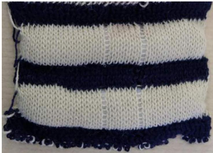
Figura 41 - Amostra com efeito de riscas horizontais e efeito 3D tubular produzido por inserção de manta acrílica.
