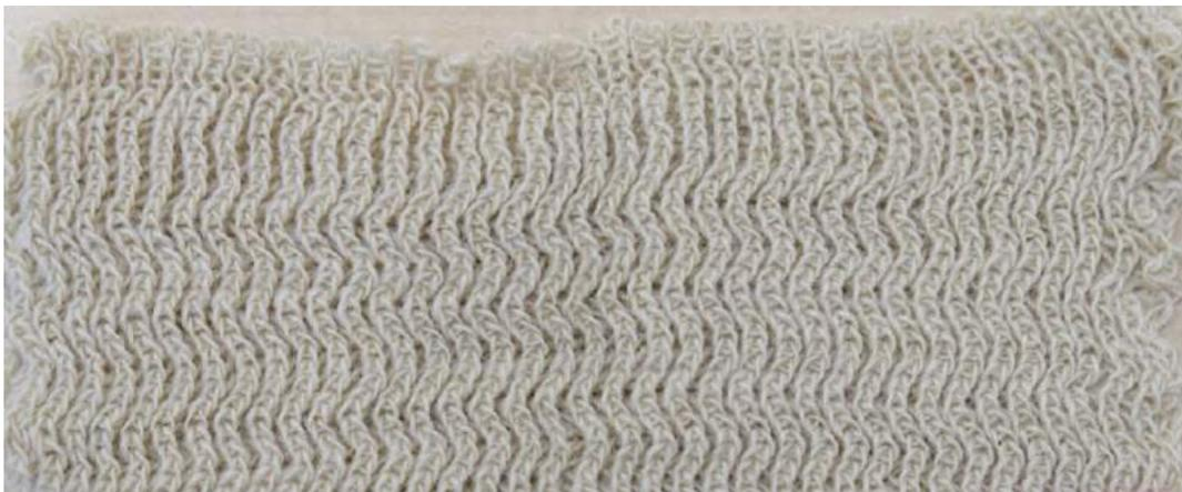
Figura 36 - Amostra cardigã com torcimento de bancada de 1 agulha em 6 passagens para a direita e esquerda
