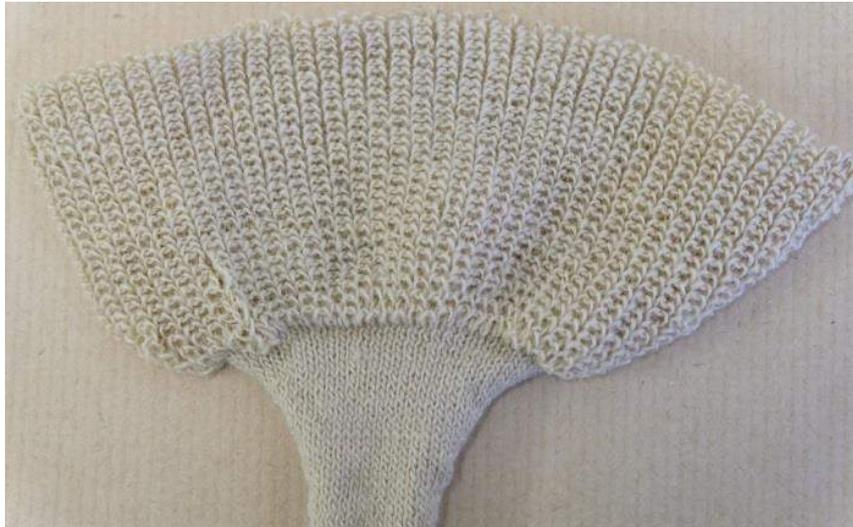
Figura 38 - Amostra de *jersey* com transferência de laçadas.
