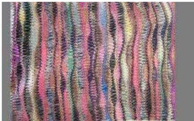
Figura 11 - Malha de trama com efeitos 3D e de cor. Fonte: <http://www.tkp.co.uk>
