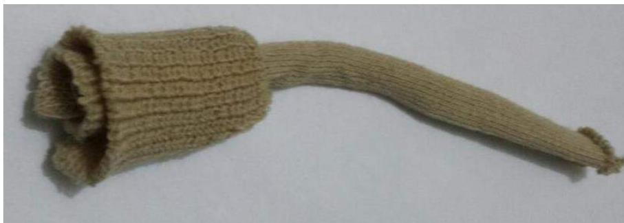
Figura 39 - Amostra de *jersey* com transferência de laçadas em forma de flor.
