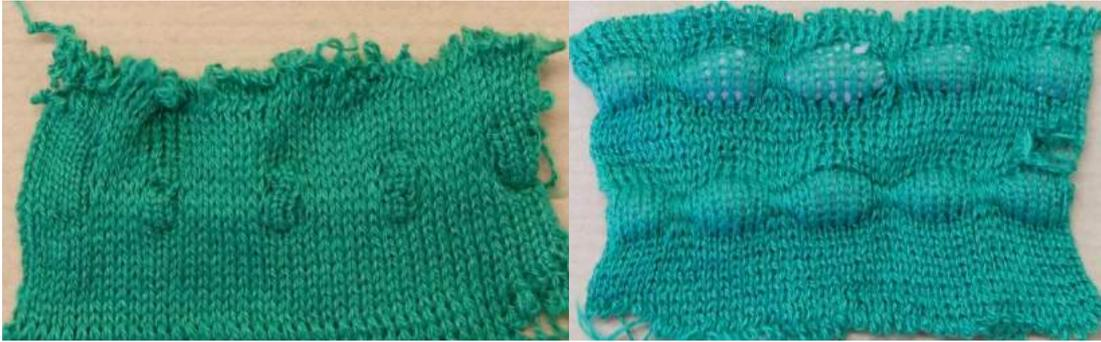
Figura 43 - Amostras com efeitos “canelados” tubulares sem e com inserção de manta acrílica.
