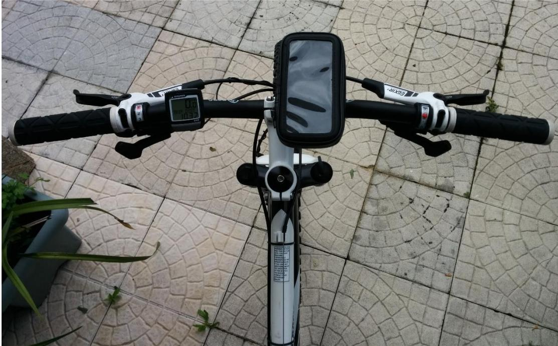
**Figura 69 – Suporte utilizado para o smartphone no teste da trepidação.**
