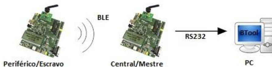
Figura 3.6 - Configuração do ambiente de testes com software BTool.
