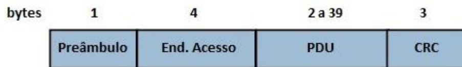
Figura 2.12 – Formato geral de um pacote BLE (adaptado de [15]).
