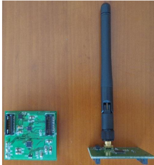
Figura 3.2 - Constituição do nó sensorial (à esquerda o módulo sensorial e à direita o módulo de interface rádio).
