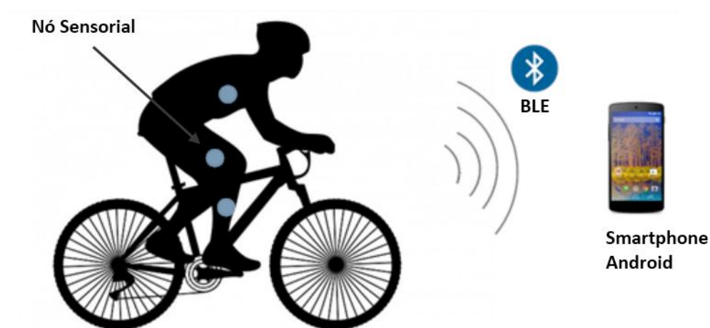
Figura 3.1 - Arquitetura do sistema de monitorização de postura.
