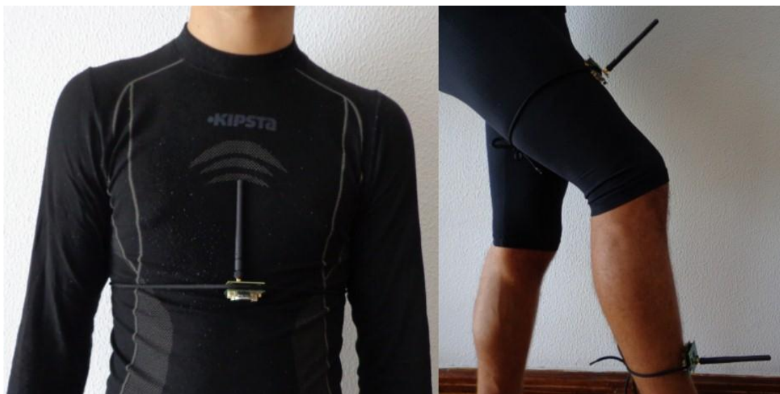
Figura 5.16 - Colocação dos sensores: no tronco (esq.) e na perna (dir.).
