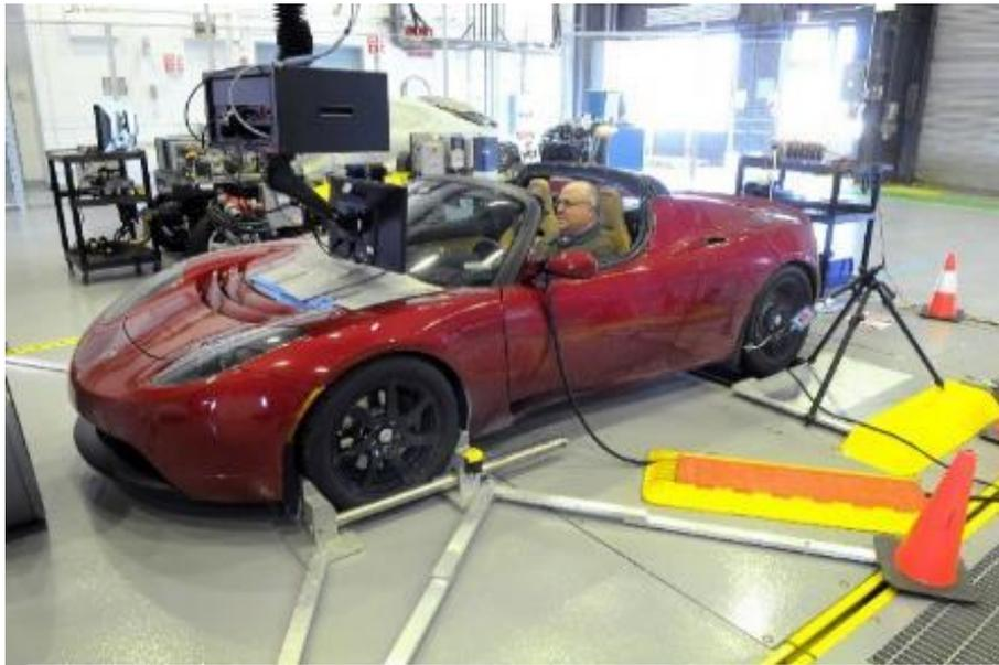
Figura 2.3 - Teste no dinamómetro de rolos
