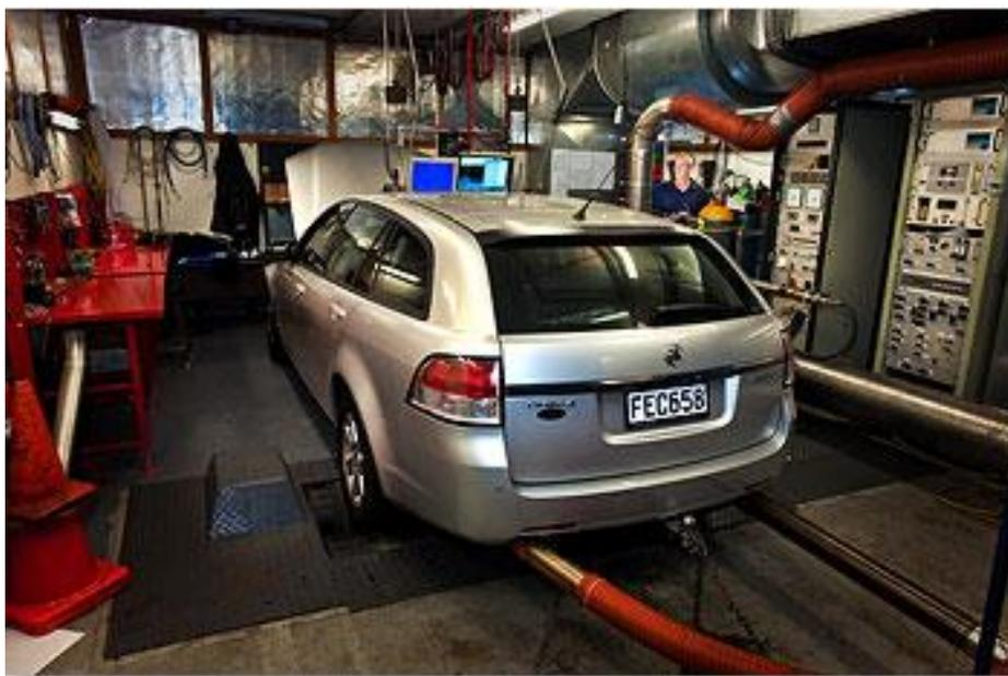
Figura 2.4 – Pormenor do tubo no escape para medição das emissões poluentes
