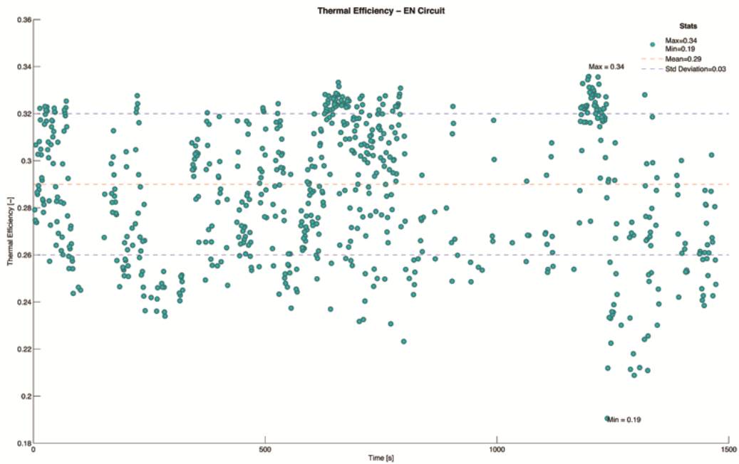
Figura 115 - Rendimento do motor durante o circuito EN
