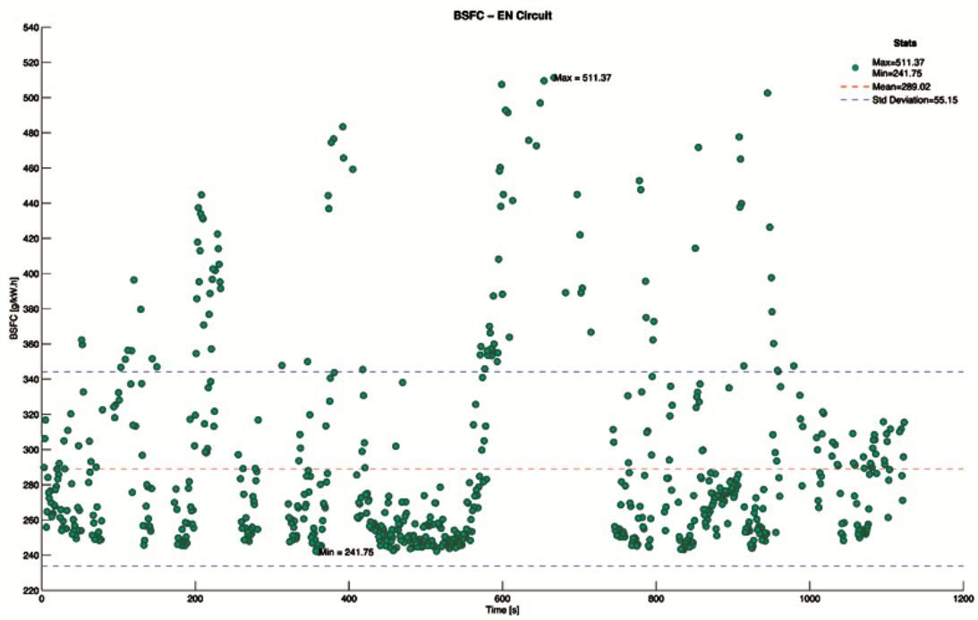
Figura 125 - Consumo específico do motor durante o percurso de AE
