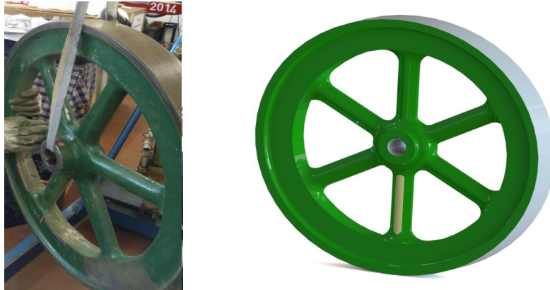
Figura 3.2 Roda de inércia e roda de inércia em desenho CAD 3D.
