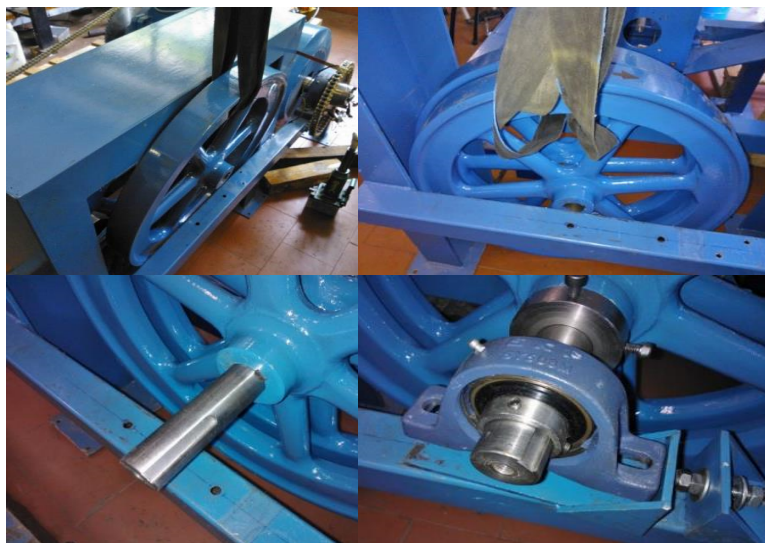
Figura 4.16 Montagem rodas de inércia.
