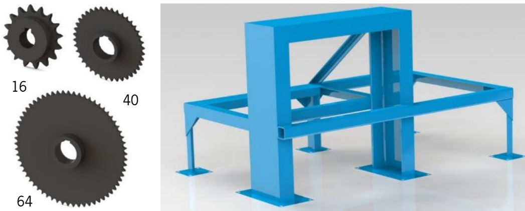
Figura 4.9 Pinhões e estrutura do banco de ensaios.
