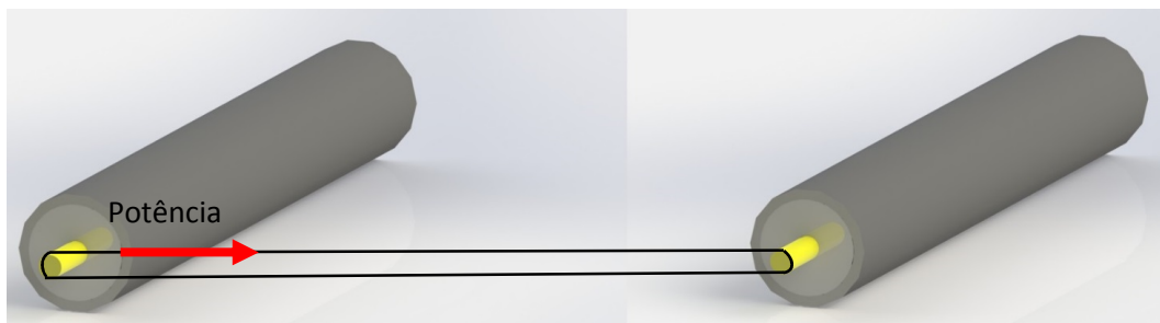
Figura 5.12 Transmissão de potência por correias dentadas.
