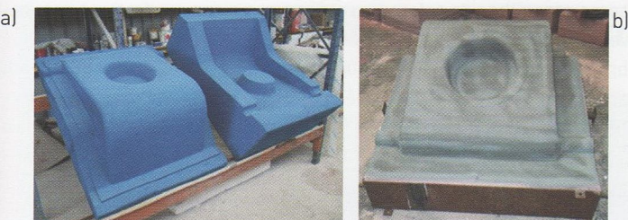
F8 – a) Modelos em poliuretano; b) Molde em areia.
