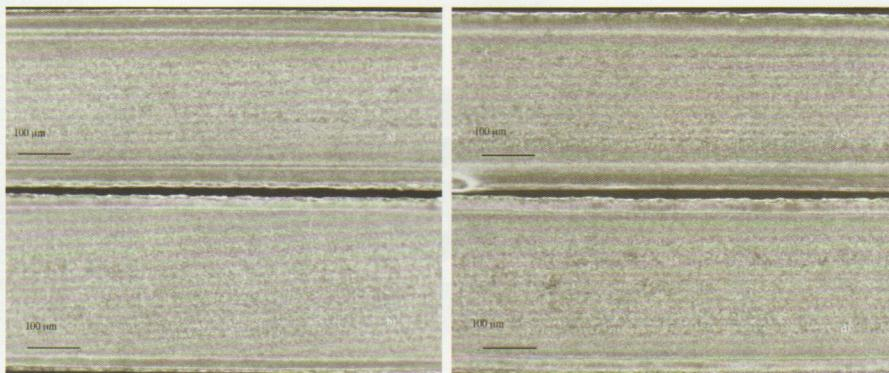
Como esperado para os polímeros semi-cristalinos, as imagens obtidas mostram uma configuração típica com uma morfologia casca-núcleo, devido às condições impostas durante a fase de processamento. O desenvolvimento da morfologia é controlado pelo ambiente termomecânico imposto ao material no interior do molde, resultando em peças com diferentes propriedades.
