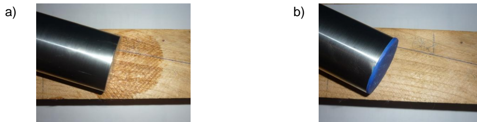
Figura 2 - Aparência da superfície do elemento após medição com ultrassons aplicando: a) gel; b) plasticina.
