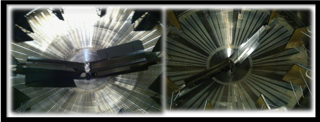
Figura 21 – Estado da caldeira após o processo de CIP e de um fabrico, após alterações no agitador.
