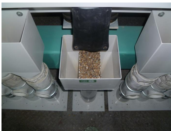
Figura 29- Resíduos à Saída da Combicleaner (equipamento de limpeza do malte e cevada).
