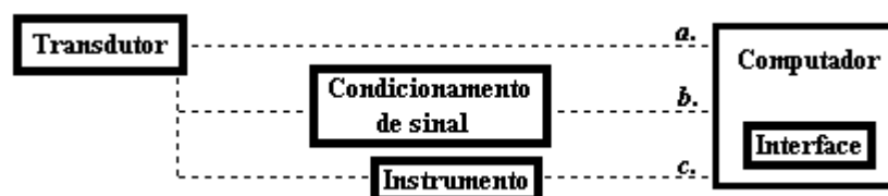
Figura 1.5. Métodos de ligação de um transdutor a um computador,
