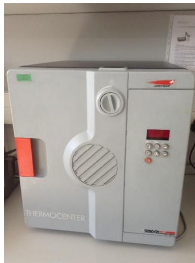
Figura 12 - Estufa Thermocenter da SalvisLab utilizada para os processos de secagem e termofixação.
