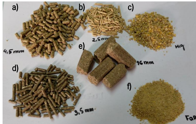
Figura 35 – Aspeto de alguns dos alimentos para animais produzidos na Nanta Portugal. a) Alimento composto granulado com diâmetro de 4,5 mm; b) Alimento composto granulado com diâmetro de 2,5 mm; c) Alimento composto em migalha; d) Alimento composto granulado com diâmetro de 3,5 mm; e) Alimento composto em grânulo com largura de 16 mm (também conhecido por taco); f) Alimento composto em farinha.
