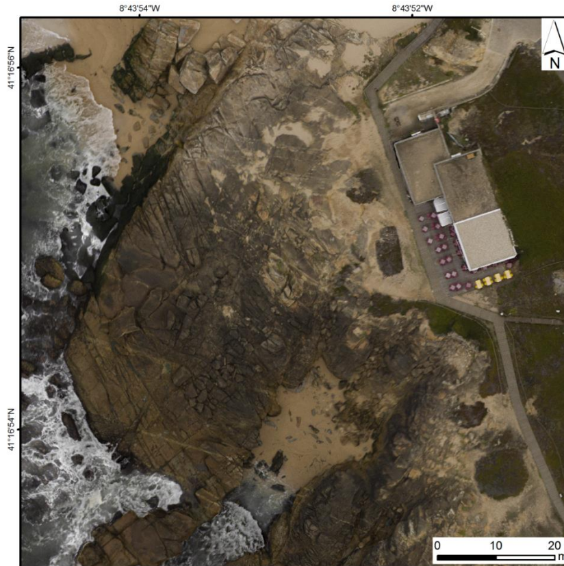
Figura 4 – Aspecto do ortofotomapa da área de S.Paio, onde é possível observar diversos detalhes geológicos e geomorfológicos (alinhamentos estruturais, arribas, filões, ...).
