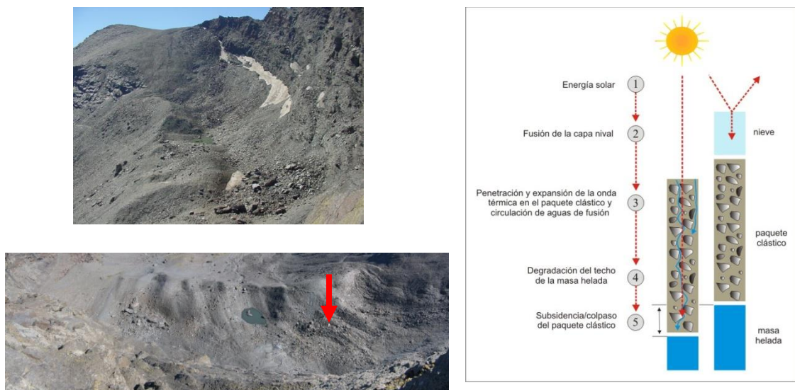
Figura 1. Corral del Veleta, vista general y particular de su base con indicación del glaciar rocoso (izquierda) y esquema de degradación de los cuerpos helados a partir de procesos físicos en cascada (derecha).
