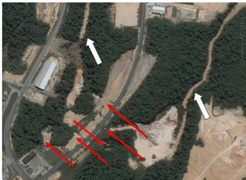
Figura 2: As setas brancas indicam os canais assoreados pelo material oriundo das Voçorocas (setas vermelhas). Fonte: Google Earth , 2007 modificado por Armando B. da Frota Filho, 2012.
