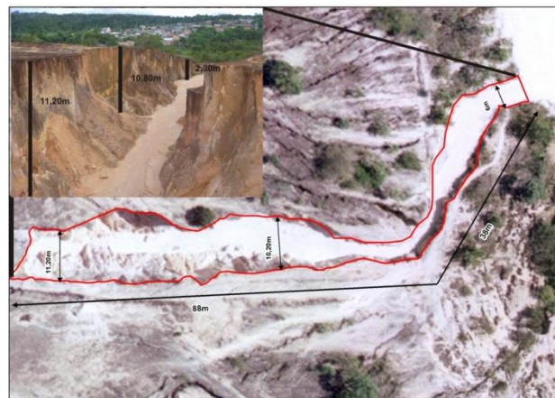
Figura 04: Vista da voçoroca em perfil e planta. Nova Cidade/Manaus.
