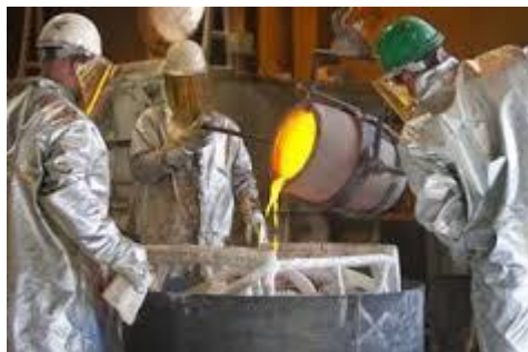
Fig. 8 Processos de fabrico de rodas dentadas metálicas: fundição e maquinagem
