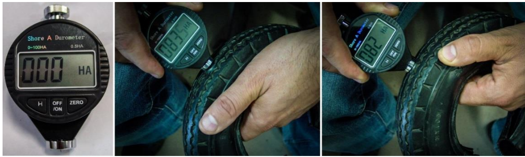
Figura 3.23 – Teste da rigidez do pneu: a) Equipamento Durometer ; b) Medição no ponto 1; c) Medição no ponto 2
