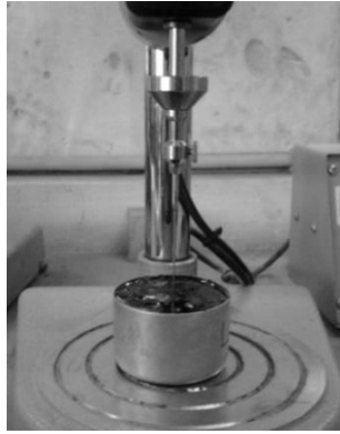
Figura 3.9 – Ensaio de Penetração a 25 °C com agulha
