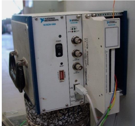
Figura 3.18 – Placa de aquisição de dados utilizada no ensaio de avaliação de consumos energéticos
