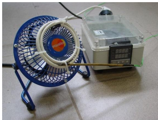
Figura 3.15 – Sistema de controlo de temperatura
