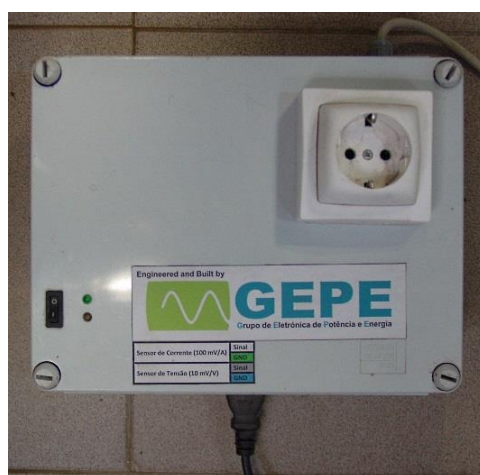
Figura 3.17 – Multímetro utilizado no ensaio de avaliação de consumos energético
