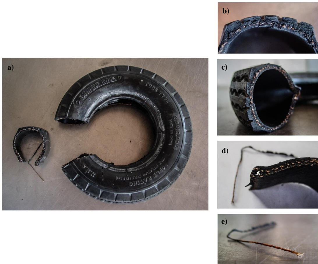
Figura 3.24 –Pneu utilizado nos ensaios: a) Pneu e secção de corte b) Almofada de proteção e carcaça; c) Secção transversal; d) Arame do talão; e) Fio da carcaça
