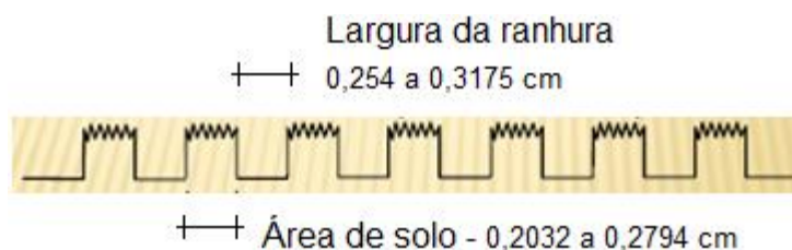
Figura 2.14 – Dimensões usuais para a textura ranhurada com rugosidade (Adaptado de Frentress (2012))
