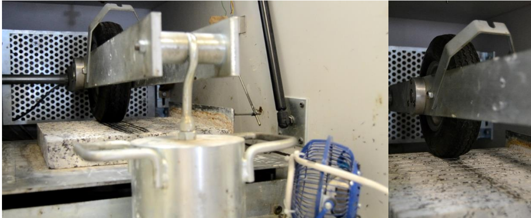
Figura 3.14 – Equipamento do ensaio de pista com roda pneumática: a) Com carga adicional e b) Pormenor do percurso da roda sobre a superfície
