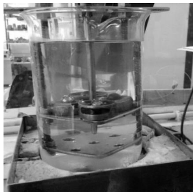
Figura 3.10 – Ensaio de determinação da Temperatura de Amolecimento
