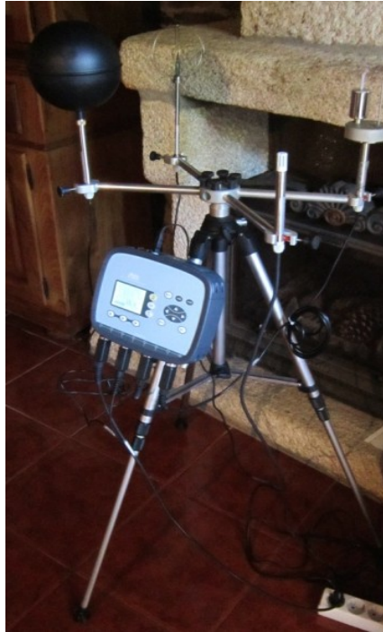
Figura 11 – Estação de conforto (equipamento da marca Delta Ohm, modelo HD32.1 Thermal Microclimate)
