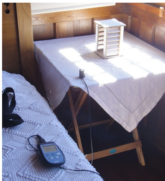
Figura 41 – Medição da luminosidade no compartimento quarto/varanda
