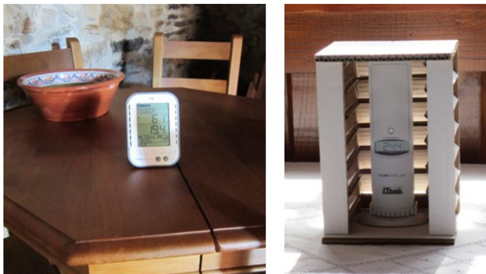
Figura 35 – (esquerda) Data logger colocado na sala/cozinha; (direita) Transmissor colocado no quarto/varanda com a proteção da radiação solar
